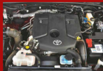
Nowoczesny silnik 2.4 nie ma koła dwumasowego ze skrzynią manualną.
