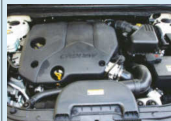
Silnik 1.6 CRDi nie ma koła dwumasowego, jeśli skrzynia jest manualna.
