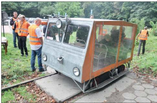
Fani kolei wozili chętnych z Obory do Dębicza drezynką wykorzystującą silnik fiata 126p
