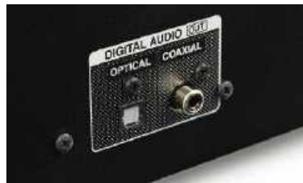
Wobec zaawansowanej sekcji cyfrowej wyjścia optyczne i współosiowe są w zasadzie zbędnymi dodatkami.
