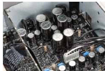
W sekcji analogowej zastosowano wyłącznie elementy dyskretnie.
