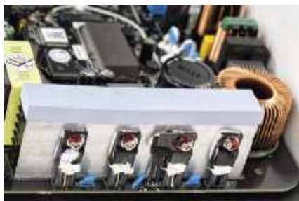
Końcówki mocy pracujące w klasie D są oparte na układach Texas Instruments TPA3255.
