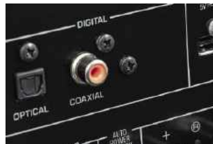
Sekcja cyfrowa jest skromniejsza niż analogowa, ale skoro coraz częściej podłączamy do wzmacniacza stereo telewizor, to może przydać się wejście optyczne.
