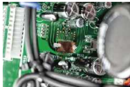
Potencjometr tylko steruje właściwym regulatorem głośności.
