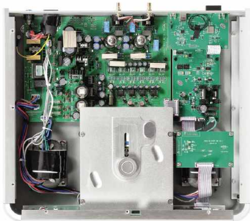
Układy elektroniczne rozplanowano na kilku płytkach, czego wymagała m.in. rozbudowana, podwójna sekcja analogowa.
