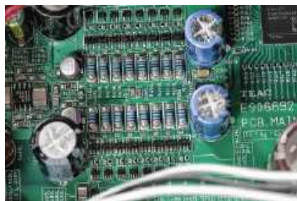
VRDS-701 jest wyposażony w oryginalny przetwornik cyfrowo-analogowy oparty na precyzyjnych rezystorach i nowoczesnych modułach sterujących.
