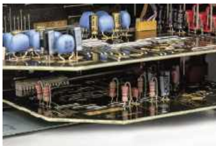
Przedwzmacniacz gramofonowy oraz wejście CD zajmują wewnątrz odrębny moduł.
