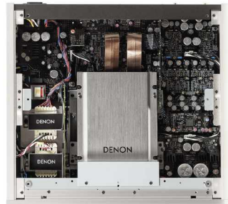
DCD-3000NE nie należy do urządzeń, w których "hula wiatr"; układy są rozbudowane, począwszy od zasilacza, przez sekcję cyfrową, aż po analogową.
