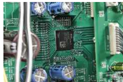
Regulacja głośności jest analogowa, bazuje na układzie scalonym JRC.
