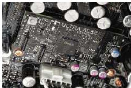
Najważniejszym firmowym układem jest Ultra AL32 Processing stosowany (i udoskonalany) przez Denona niemal od początku historii CD.
