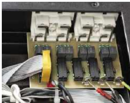
Sygnał ze źródeł przełączają ciche kontaktrony, umieszczone na niewielkiej płytce obok gniazd RCA.
