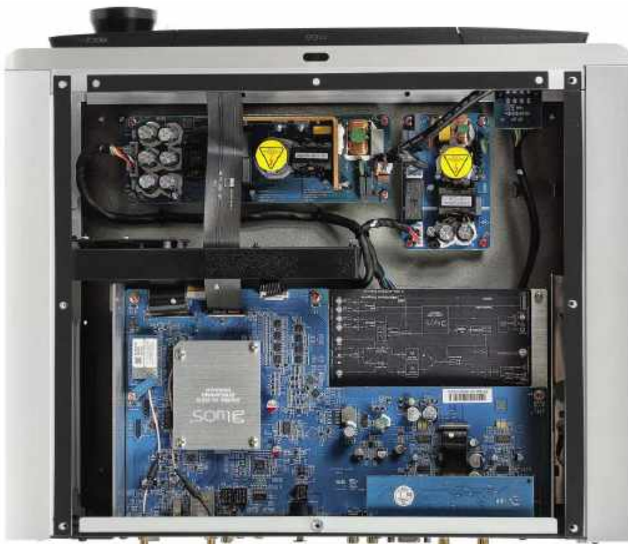
Moduł BluOS umieszczono w metalowym ekranie. Impulsowe zasilacze ułożono w przedniej części obudowy.
