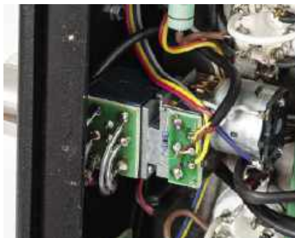
VA950 można też uznać za hybrydową... końcówkę mocy z pasywnym przedwzmacniaczem – jednym z pierwszych elementów w torze sygnałowym jest potencjometr
