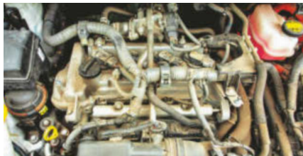
WOLNOŚĄCA JEDNOSTKA spalinowa jest wyposażona w trwałe napęd rozrządu realizowany łańcuchem. Wycieki są bardzo rzadkie.
