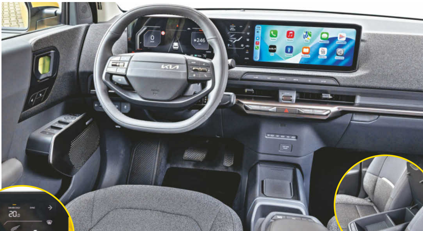
Plastiki są twarde, ale schludne i porządnie zmontowane, a estetykę poprawiają powierzchnie udające metal oraz tapicerowane wstawki. Czytelne interfejsy, przełączniki do regulacji wentylacji ułatwiają obsługę. Z lewej – środkowy ekran „klimy” zasłania kierownicę. Z prawej: liczne schowki.
