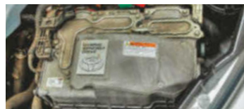
OBSŁUGA układu hybrydowego wymaga uprawnień SEP G1 (do 1 kV).
