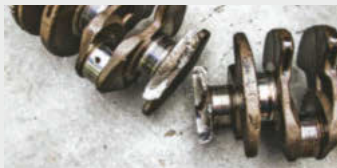
Pęknięcie wału korbowego może być związane z niskim poziomem oleju.
