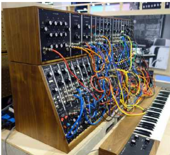
Fotografia 2. Syntezator modularny Moog System 55, edycja limitowana z 2015 roku. Brzmienie jest tworzone przez łączenie kablami poszczególnych modułów i regulowanie ich nastaw. Im więcej dostępnych modułów w tego typu syntezatorze, tym bardziej rozbudowane i różnorodne brzmienia można tworzyć za jego pomocą ( https://t.ly/sp_0G )
