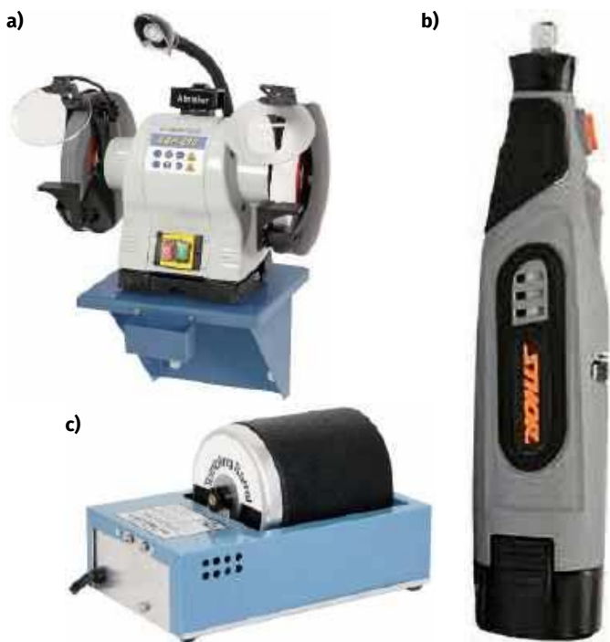
Rysunek 11. Przykłady urządzeń do szlifowania: dwutarcowa szlifierka stołowa [15] (a), miniszlifierka manualna [16] (b) oraz polerka bębnowa [17] (c)
