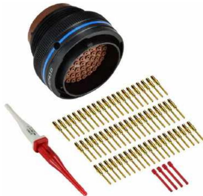
Fotografia 1. Złącze typu MIL-DTL-26482 produkcji Aero Electric ( https://www.prowireusa.com/ ) ma aluminiową, niklowaną obudowę i złocionymi pinami z fosforbrązu. Dostępna jest również wersja w obudowie z pokryciem kadmowym lub anodyzowana na czarno
