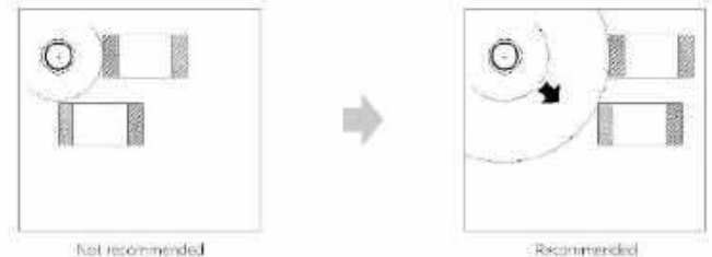
Rysunek 7. Zalecenie dotyczące umieszczania kondensatorów MLCC (w miarę możliwości) z dala od otworów montażowych PCB ( https://t.ly/kwPHT )
