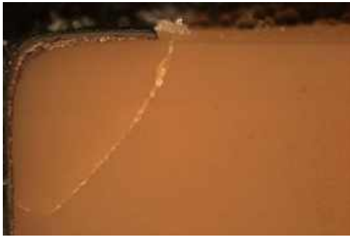
Fotografia 1. Skośnie przebiegająca szczelina będąca wynikiem uszkodzenia typu flex cracking ( https://t.ly/s67CV )
