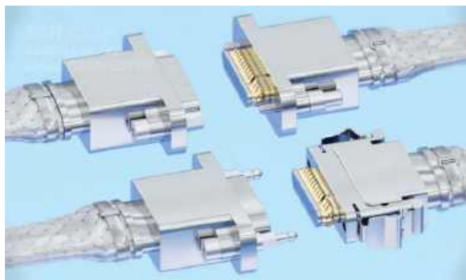
Fotografia 11. Złącza Micro-D firmy Axon, wyposażone w szybkozłącza z dodatkowymi zapieczętowaniami, zabezpieczające przed rozłączeniem na skutek wibracji. Widoczne są także metalowe peszle kablowe (również metalowymi) spinkami, zabezpieczające przewody przed uszkodzeniem oraz EMI ( https://www.axon-cable.com/ )
