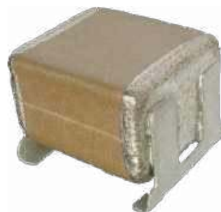
Fotografia 4. Kondensator z metalowymi wyprowadzeniami zmniejszającymi naprężenia mechaniczne, przenoszone z płytki drukowanej na ceramiczny korpus elementu ( https://t.ly/u9W1Q )
