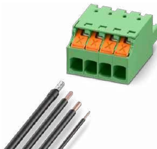
Fotografia 2. Technologia Push-X umożliwia beznarzędziowy montaż wszystkich typów przewodów
