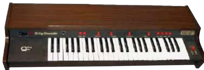
Fotografia 1. Syntezytor monolityczny Solina pozwalający tworzyć brzmienia naśladujące sekcję smyczkową orkiestry ( https://t.ly/yPIFs )
