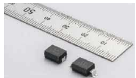
Fotografia 9. Kondensatory zalewane żywicą, o zwiększonym odstępem powietrznym i powierzchniowym ( https://t.ly/ms51p )
