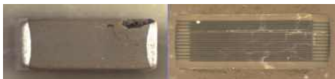
Fotografia 3. Kondensator uszkodzony przez wysokie napięcie – widoczne poważne uszkodzenia zewnętrzne oraz obszerna delaminacja wewnątrz korpusu elementu ( https://t.ly/Kul_1 )
