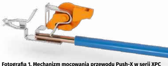
Fotografia 1. Mechanizm mocowania przewodu Push-X w serii XPC
