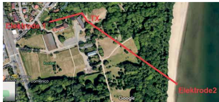
Schemat eksperymentalnej anteny dipol ziemny rozciągniętej w Gdyni
