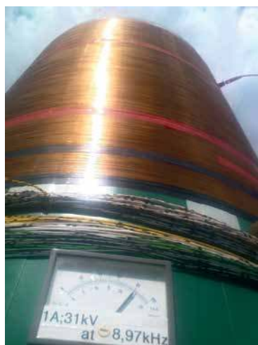
Antena dopasowująca DK7FC do anteny pionowej unoszonej za pomocą latawca
