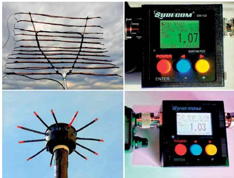
Konstrukcje antenowe Adama HF7ST i wyniki pomiarów
