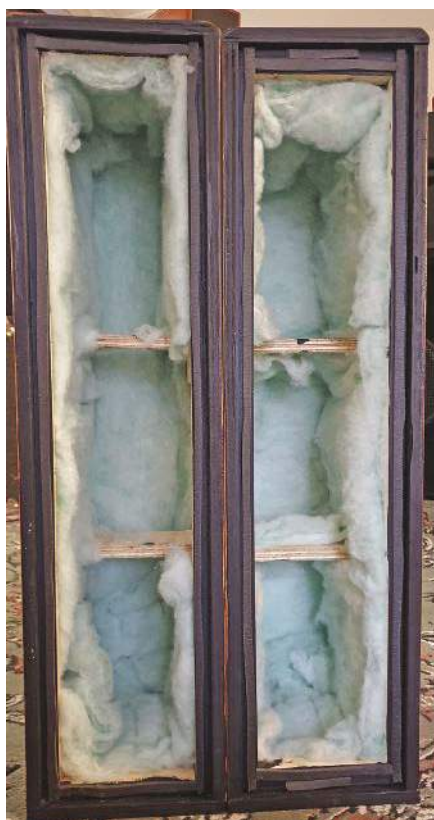
Tu widać, jak wata akustyczna jest mocowana w obudowach głośników. W rzeczywistości są to skrzynki subwooferów, którymi zajmiemy się w przyszłym miesiącu, ale zasada jest ta sama.
