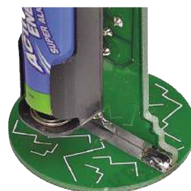
Aby połączyć obie płytki razem, najpierw „przyklej” je lutem, a następnie przeprowadź lut wzdłuż ścieżek z cynowanej miedzi na płytce. Będzie to mocne połączenie!
