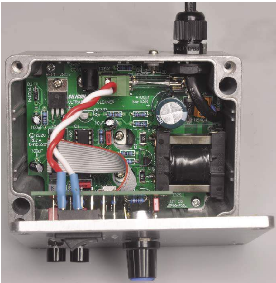
Ta fotografia pokazuje, jak będzie wyglądać ukończona myjka ultradźwiękowa, gdy w przyszłym miesiącu zajmiemy się budową i testowaniem. Pokażemy również, jak skonfigurować wanny do mycia ultradźwiękowego przy użyciu tanich pojemników „kuchennych”.
