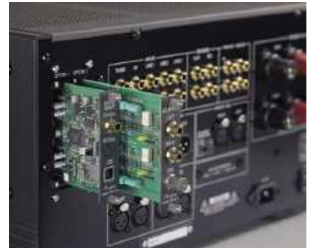
Karty rozszerzeń pozwolą podłączyć gramofon i źródła cyfrowe.
