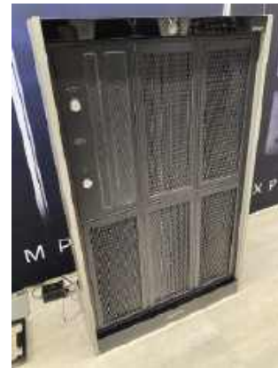
Dwa zdania o technice. Origin wykorzystuje przetworniki elektrostatyczne, ale w dość niekonwencjonalny sposób. W systemie pracują przetworniki o różnej wielkości i różnych charakterystykach, wszystkie podłączone są do niefiltrowanego (elektrycznie) sygnału ze wzmacniacza. Generują bardzo dużo rezonansów, ale ich spektrum jest tak szerokie i gęste, że wypadkowa charakterystyka (i brzmienie) są zrównoważone. O ile dobrze zrozumiałem...
