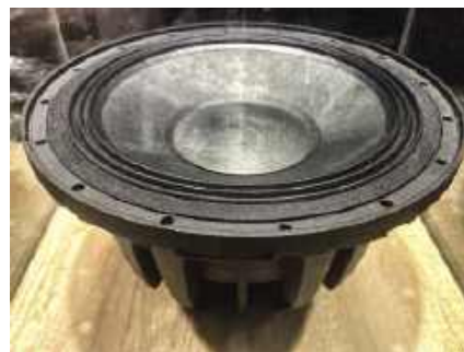
25-cm głośnik nisko-średniotonowy, celuloza na tekstylnym zawieszaniu.
