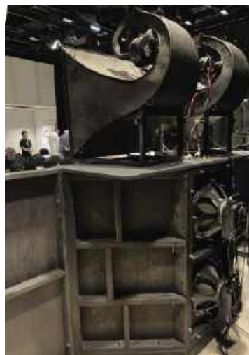
Na górze driversy 555, na dole 18-calowe niskotonowe 4181, wszystkie z elektromagnesami.
