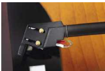
Rurka jest prosta, główka blokowana od dołu, po zwolnieniu można ją obracać, regulując azymut wkładki.
