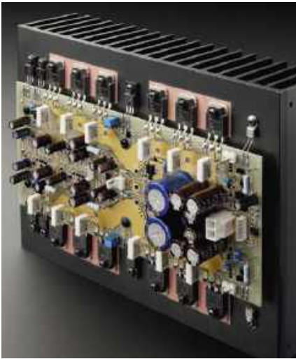
Końcówki mocy podzielono na dwa moduły uzbrojone w tranzystory MOSFET.
