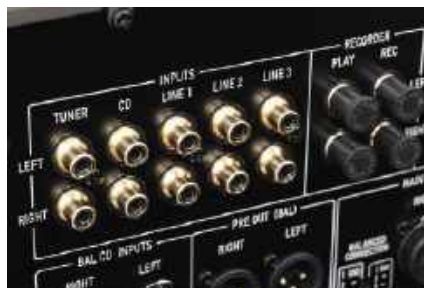
Za wejściami RCA sygnał jest symetryzowany.
