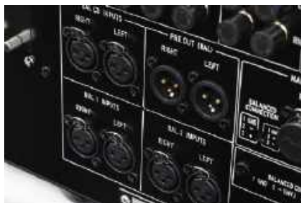
E-800S jest konstrukcją w pełni zbalansowaną, warto korzystać z wejść XLR.
