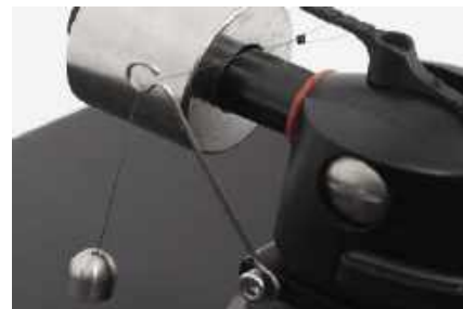
Tradycyjny system anti-skatingu z ciężarkiem na żyłce nie jest wygodny, lecz wciąż pozostaje najdokładniejszy.
