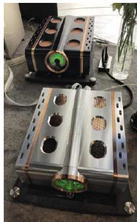
Referencyjne monobloki Relentless Z Monoblock; niższa impedancja wejściowa (nowej wersji Z) zapewnia efektywną współpracę z przedwzmacniaczem Relentless Z Preamplifier, który z kolei ma większą wydajność prądową stopnia wyjściowego
