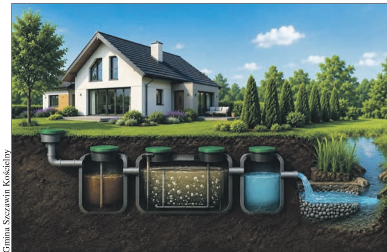
Wizualizacja przydomowej oczyszczalni ścieków
