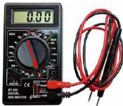
Rysunek 3. Miernik skonfigurowany na funkcję badania ciągłości obwodu. Jeśli elektrody przyłożone do diody LED spowodują jej zaświecenie, przewód czerwony wskazuje anodę, czyli „plus” diody LED
