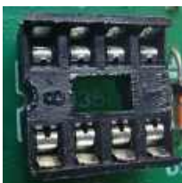
Fotografia 8. Podstawka powinna zostać zamontowana w kierunku zapewniającym zgodność wcięcia na białym opisie na płytce drukowanej i wcięcia na jednym z boków podstawki. Docełowo w tej podstawce zostanie osadzony układ scalony. Również w tym samym kierunku
