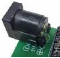
Fotografia 15. Typowe gniazdko zasilania 2.1/5.5 mm (barrel jack) zamontowane w otworach przewidzianych do prowadzenia kabli baterii 9 V
