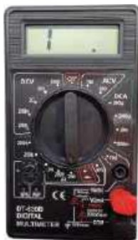
Fotografia 4. Wskazanie multimetru podczas pomiaru rezystora sugerujące przekroczenie zakresu pomiarowego. Na ustawionym zakresie nie można wykonać pomiaru, zakres należy przełączyć na wyższy
