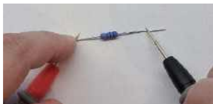
Fotografia 5. Poprawny sposób przykładania sond pomiarowych do badanego rezystora. Można wspomóc się palcem, ale tylko na jednym z wyprowadzeń rezystora, by nie wprowadzić do obwodu dodatkowej rezystancji naszego ciała
