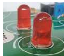
Fotografia 12. Widoczna z bliska większa elektroda we wnętrzu diody LED to zazwyczaj katoda, czyli elektroda ujemna diody LED. Przyłutowana dioda zastania znaczek „+” na opisie PCB, ale widać, że większa elektroda jest skierowana w stronę ścicia namalowanego na obwodzie okręgu symbolu diody LED, czyli do minusa
