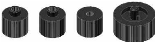
2. Wygląd zewnętrzny modeli nowych pokręteł wykonanych na drukarce 3D
