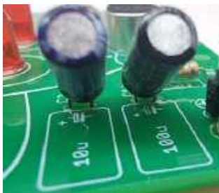
Fotografia 14. Znak „+” w obrysie kondensatorów na płytce PCB wskazuje otwór, w który należy zamontować dłuższe wyprowadzenia kondensatorów elektrolitycznych
