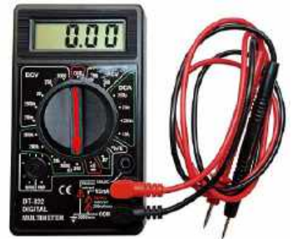
Rysunek 2. Multimetr z poprawnie podłączonymi przewodami (czerwony do złącza „VΩmA”, czarny do złącza „COM”) oraz ustawiony na funkcję pomiaru rezystancji, na najmniejszy możliwy zakres „do 200 Ω”)
