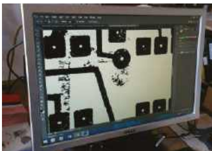
Rysunek 14. Niskiej jakości skany płytek drukowanych z projektu studenckiego J. M. Hawkesa zostały poprawione w Photoshopie do postaci umożliwiającej ich użycie do wytrawiania płytek
