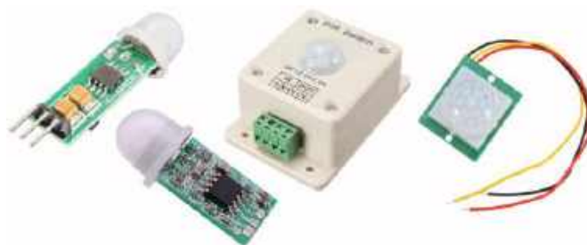
13. Kolekcja modułów z czujnikiem PIR, które można zamówić w Internecie po okazjnych cenach (© Banggood)
