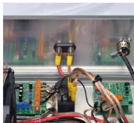
Wszystkie moduły są przymocowane do obudowy za pomocą śrub. Okablowanie między tymi modułami jest również przytwierdzone do obudowy. Dobrym pomysłem jest stosowanie dużej liczby opasek kablowych. Dzięki nim okablowanie jest bezpieczne i schludne. Należy zauważyć, że do gniazda wejściowego XLR przylutowano kondensator 560 nF
