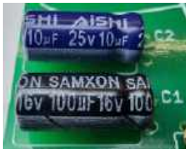
Fotografia 13. Parametry kondensatorów elektrolitycznych odczytujemy wprost z ich obudowy. Oprócz pojemności (C1 to 100 µF, C2 to 10 µF) widoczne są również wartości napięć, przy których każdy z tych kondensatorów może bezpiecznie pracować, pod warunkiem zachowania poprawnej polaryzacji zasilania. Pod wartościami widać też duże białe paski oznakowane znakiem „+”. Mogą się przydać, gdyby kondensatory z jakiegokolwiek powodu miały wyprowadzenia o jednakowej długości
