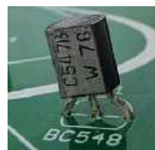
Fotografia 9. Prawidłowy montaż tranzystora T1 na płytce PCB
