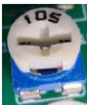
Fotografia 11. Potencjometr oznakowany jako „105”, czyli 10 i pięć zer -> 1 000 000, czyli potencjometr o wartości 1 M \Omega
