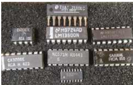
Rysunek 20. Scalone wzmacniacze transkonduktancyjne, nadające się do VCA w wokoderach. Widzimy tu klasyczny CA3080, LM13600/700, „dziwolągi” NE571 i CA3060 oraz, opracowany najpóźniej i najlepszy, CA3280. Nadal produkowane są tylko LM13700 i THAT Corporation 2180. LM13700 w obudowie dual-in-line zostanie przez Texas Instruments wkrótce wycofany z produkcji
