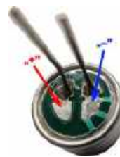
Rysunek 4. Polaryzacja mikrofonu elektretowego. Trzy ścieżki podłączone do metalowej obudowy wskazują wyprowadzenie, które należy podłączyć do „minusa”, czyli do otworu opisanego na płytce PCB znakiem „-”
