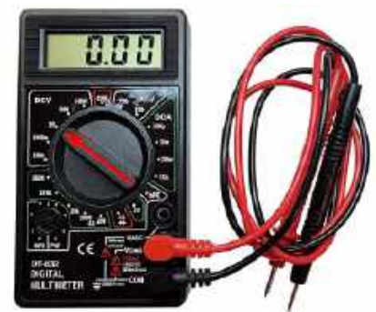
Rysunek 5. Multimetr z poprawnie podłączonymi sondami pomiarowymi, ustawiony na funkcję woltomierza napięć stałych (obszar DCV miernika) na zakres „do 20 V”
