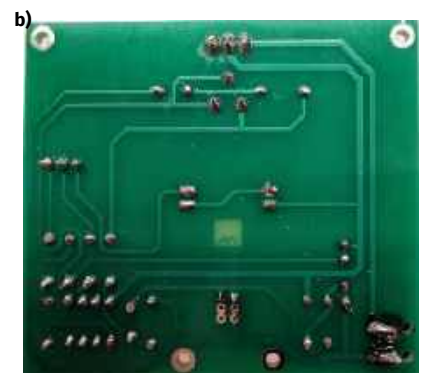
Fotografia 16. Poprawnie zmontowany zestaw Wściekły byk LED: a) widok od strony montażu komponentów, b) widok od strony lutowania
