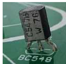
Fotografia 9. Prawidłowy montaż tranzystora T1 na płytce PCB
