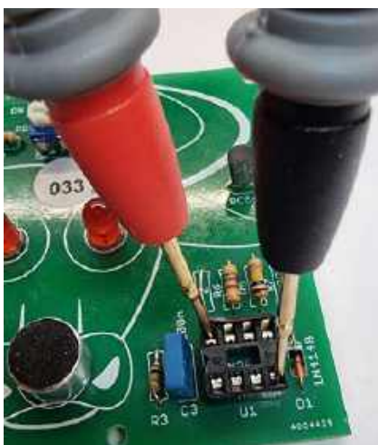
Fotografia 17. Prawidłowy sposób pomiaru napięcia na podstawie pod układ U1. Sonda czerwona łączy się z pinem nr 8 podstawki, sonda czarna z pinem 4
