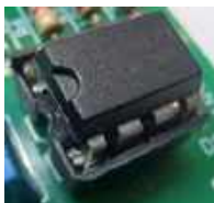
Fotografia 18. Układ LM358 zamontowany w podstawce. Zwróć uwagę, że wycięcie (znacznik polaryzacji) skierowany jest w tym samym kierunku co wycięcie na podstawie oraz białym nadrukiem na płytce PCB. Wszystkie trzy mają być zgodne
