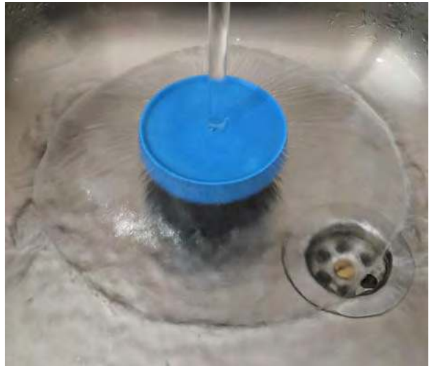
Fot. 3. Odskok hydrauliczny i rozprysk wody na pokrywce pudełka od pasty do czyszczenia naczyń.
