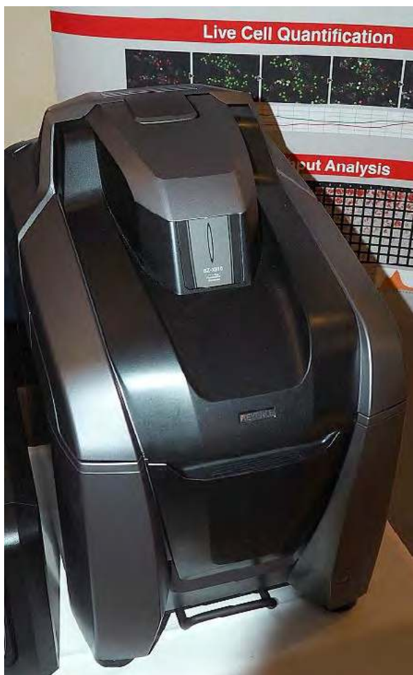
Fot. 1 Nowoczesny, kompaktowy mikroskop fluorescencyjny umożliwia prowadzenie pomiarów nawet w jasno oświetlonych pomieszczeniach.
