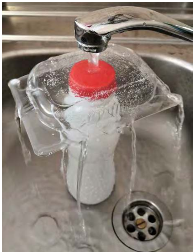
Fot. 4. Skutek użycia do doświadczenia przedmiotu o zbyt dużej powierzchni – plastikowej tacki od produktów spożywczych.
