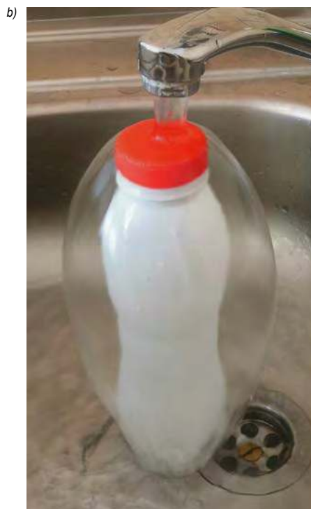
Fot. 7. Zakrzywienie dolnej powierzchni „parasola wodnego” w kierunku osiowym w zależności od prędkości wypływu: a) kształt zbliżony do powierzchni paraboloidy, b) kształt bardziej przypominający fragment powierzchni elipsoidy. Efekt uzyskano w wyniku rozpliwu wody po odrzuceniu hydraulicznym na zakrętce plastikowej butelki od kefiru.
