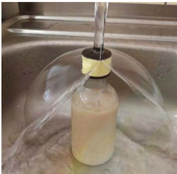
Fot. 5. „Namiocik wodny” spowodowany przez odskok hydrauliczny i rozpliw wody na zakrętce plastikowej butelki od szamponu z ogranicznikiem rozpliwu wykonanym z kawałka drutu (fragment spinacza biurowego), przymocowanym taśmą klejącą do brzegu zakrętki.
