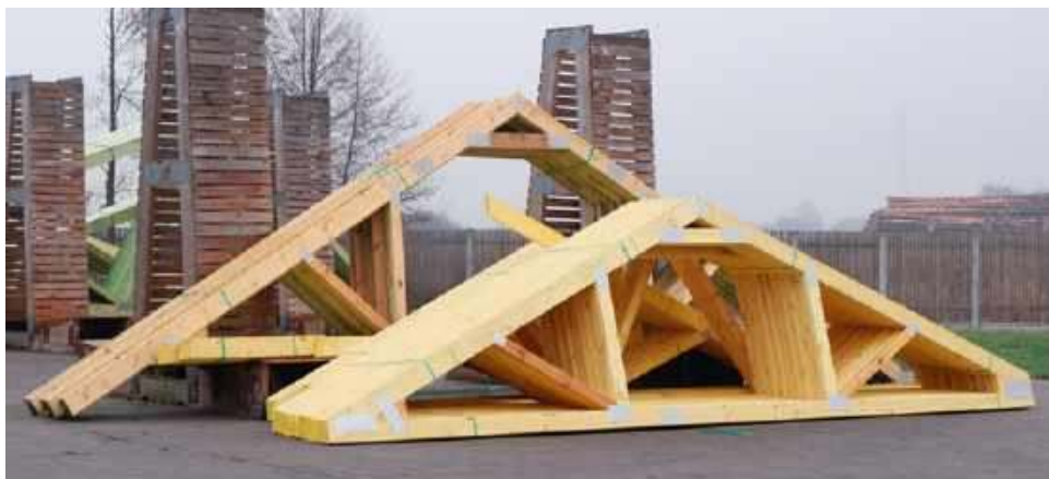
📌 Wiązary kratowe powstają w fabryce, nie na budowie. GRUPA BURKIETOWICZ
