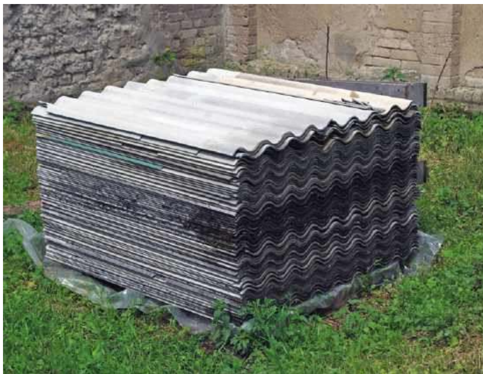
❗ Włókna azbestowe zawarte w płytach mogą powodować choroby płuc. Na szczęście materiał ten nie stanowi zagrożenia dopóki nie jest uszkodzony. FEDERACJA ZIELONYCH GAJA
