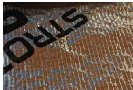
Określenie aluminiowa folia paroizolacyjna jest nieco mylące. W rzeczywistości jest to folia polietylenowa pokryta jednostronnie warstwą aluminium. J. ANTKIEWICZ
