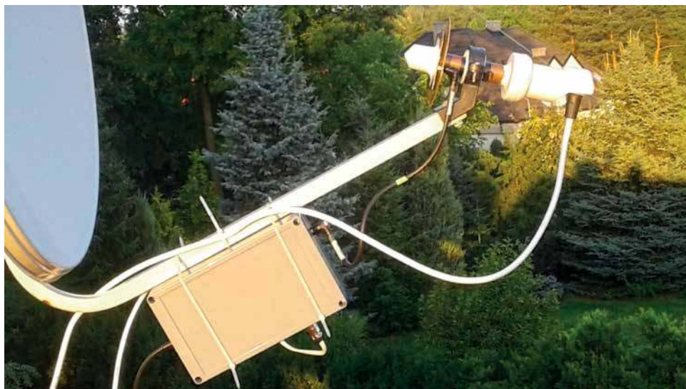
Rys. 6. Zestaw antenowy wraz ze wzmacniaczem do satelity QO-100
