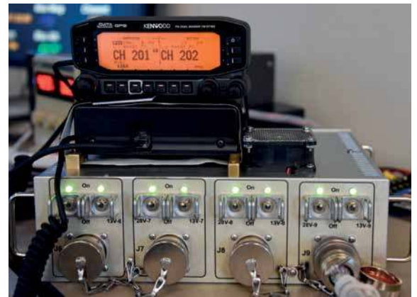
IORs składa się z radiostacji JVCKenwood D710GA i zasilacza wielonapięciowego (MVPS). Radiostacja wyświetla tylko kanały, a nie częstotliwości, jak to ma miejsce w krótkofalarskich urządzeniach radiowych JVCKenwood TM-D710GA
