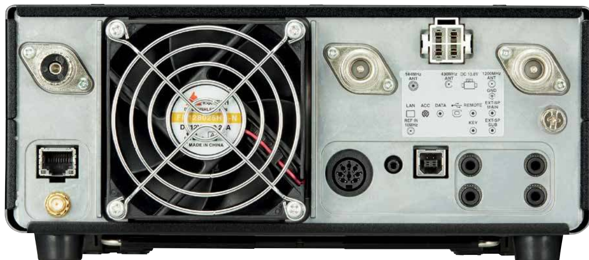
Widok tylnej ścianki z rzucającym się w oczy dużym cicho pracującym wentylatorem i trzema gniazdkami antenowymi oddzielnymi dla każdego pasma. Gniazdko LAN pozwala na połączenie z siecią lokalną, SMA służy do podłączenia wzorca częstotliwości, a ACC – do sterowania dodatkowym wyposażeniem
