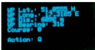
Ekran nr 3. Współrzędne zapisane w pamięci, odległość i kurs do zapamiętanego punktu oraz sugerowana zmiana kierunku marszu (<-, ->, =, Q). Dłuższe przytrzymanie przycisku wyboru zapisuje aktualne współrzędne jako współrzędne celu (WP)
