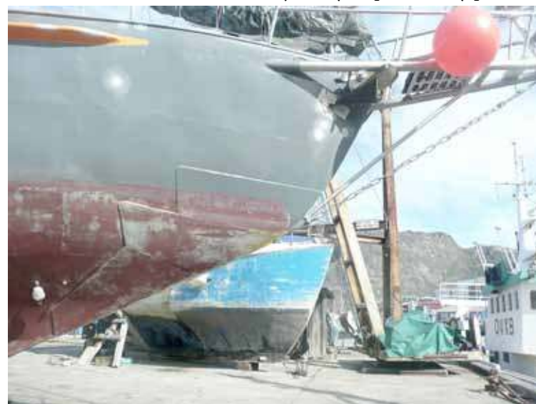
Naprawiona dziobnica jachtu po spotkaniu z górą lodową
