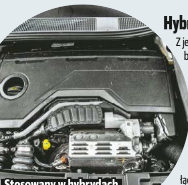
Stosowany w hybrydach silnik 1.2 PureTech ma rozrząd napędzany łańcuchem.
