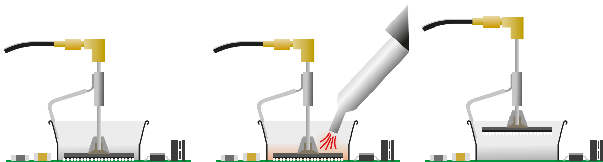
Rysunek 2. Zasada działania automatycznego ekstraktora marki JBC: po lewej – uchwycenie układu chwytakiem podciśnieniowym, w środku – ogrzewanie kolbą hot-air, po prawej – podniesienie układu po roztopieniu lutowni ( https://t.ly/4d1L )
