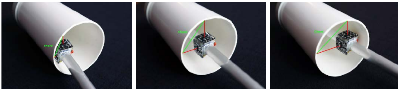
Fotografia 1. Zmieniająca się długość cięciwy przy zmianach położenia rury mierzącej wiatr
