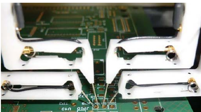
Fotografia 20. Maszyna do testów elektrycznych nieobsadzonego obwodu PCB ( https://t.ly/A2WG )
