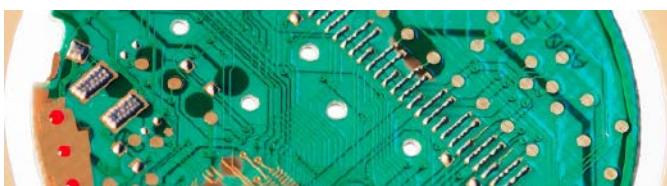
Fotografia 24. PCB z pastą lutowniczą nałożoną za pomocą dyspensera. Widoczne charakterystyczne nierówności wynikające z ograniczeń procesu technologicznego ( https://t.ly/8XXW )
