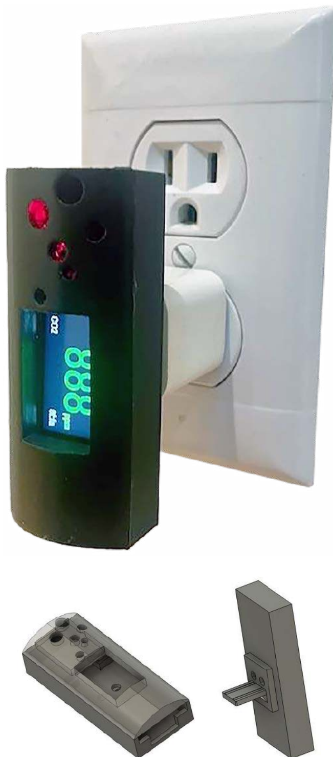
Rysunek 1. Projekt obudowy urządzenia, przeznaczonej do wykonania w technice druku 3D
