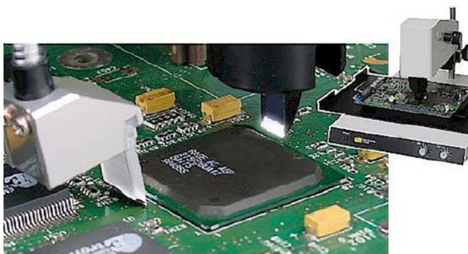
Fotografia 47. Głowice optyczne do obrazowania połączeń pod układem BGA ( https://t.ly/66Hp )
