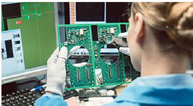
Fotografia 34. Wstępna inspekcja wzrokowa zmontowanych PCB ( https://t.ly/mYNX )
