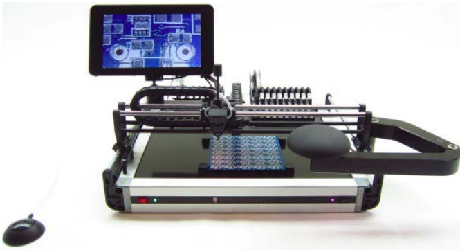
Fotografia 29. System wspomaganie manualnego układania elementów SMD o nazwie SMT Caddy ( https://t.ly/n1CZ )
