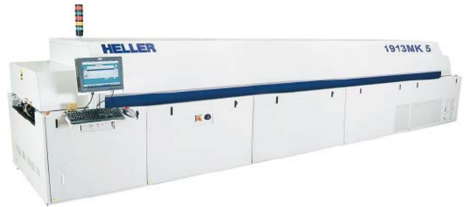
Fotografia 31. Wielostrefowy piec do lutowania rozpliwowego ( https://t.ly/RoLK )
