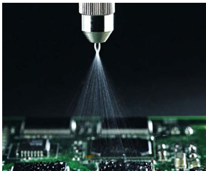
Fotografia 36. Natrysk ochronnej powłoki konformalnej ( https://t.ly/MjnS )
