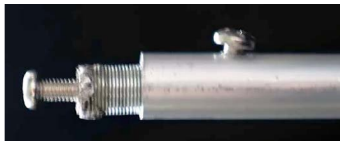
Fotografia 2. Montaż sprężyny, do której będzie zawieszona rura
