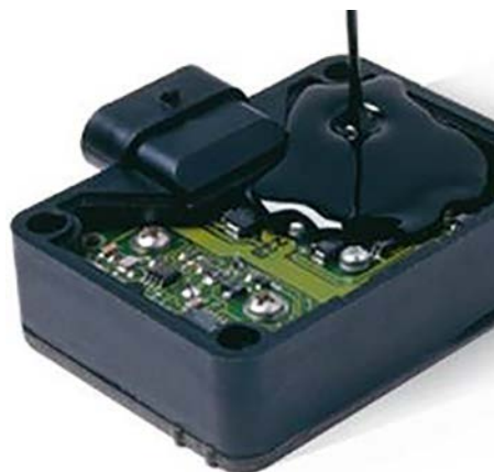
Fotografia 37. Zalewanie modułu żywicą ochronną ( https://t.ly/op73 )
