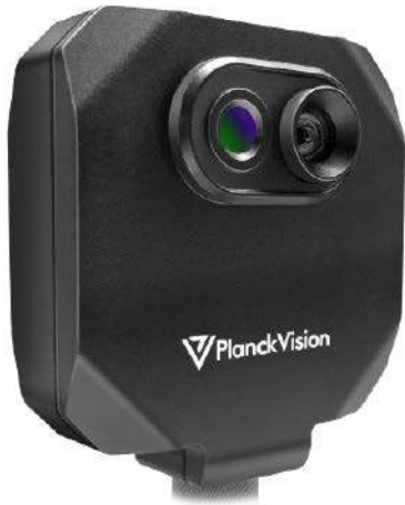
Fotografia 1. Niewielka kamera termowizyjna PVS-TC160-EU o dokładności 0,3°C
