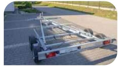
Podwozie typu Lift&Go – element wózka jezdnego
