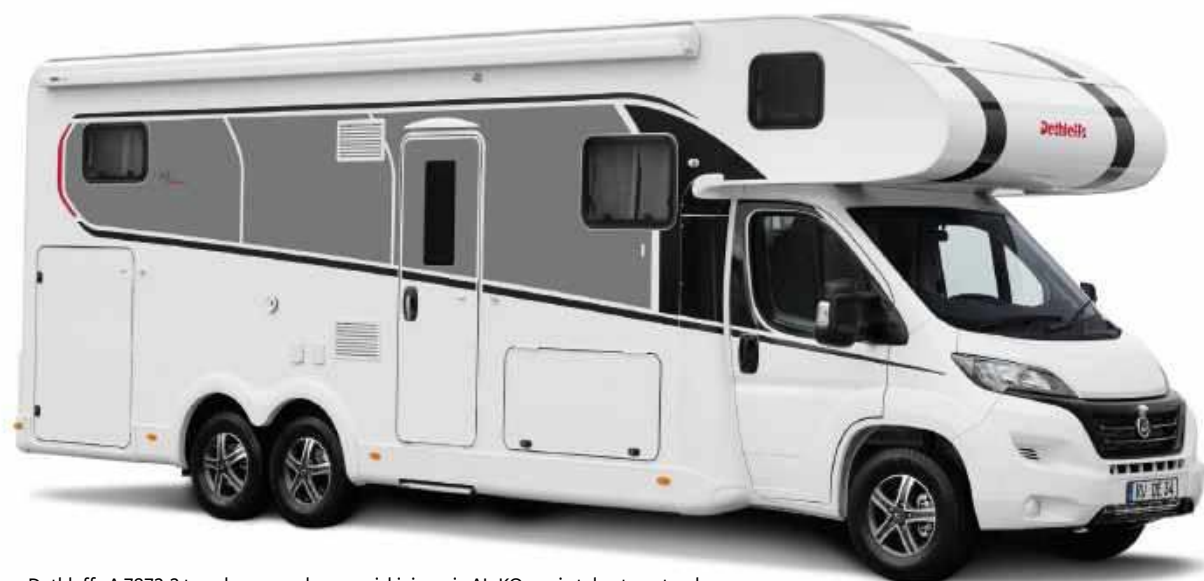
Dethleffs A 7872-2 to całoroczny dom na niskiej ramie AL-KO z osią tylną typu tandem
