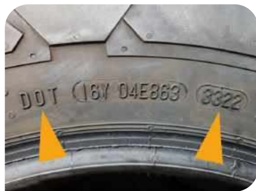
By faktycznie korzystać z uprawnień „Tempo 100”, opony w przyczepie nie mogą być starsze niż 6-letnie. Ich rok produkcji uwidocznił się w formie czterocyfrowego kodu
