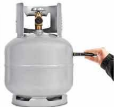
Ręczne pomiary ultradźwiękowym przyrządem można wykonać na butlach stalowych i aluminiowych. Taka metoda wymaga nieco wprawy
