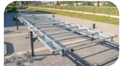
Lift&Go – rama; na tym szkieletie powstaje tiny house
