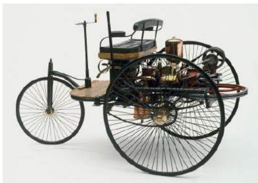
Patent-Motorwagen Nummer 1 Karla Benz – za siedzeniem widoczny mosiężny zbiornik na wodę, z którego spływała do płaszcz wodnego nalutowanego na cylinder
