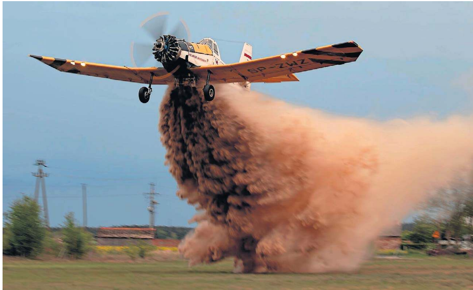
Gdy zrzuca się dwie tony wody, samolot potrafi wyskoczyć kilkadziesiąt metrów w górę
