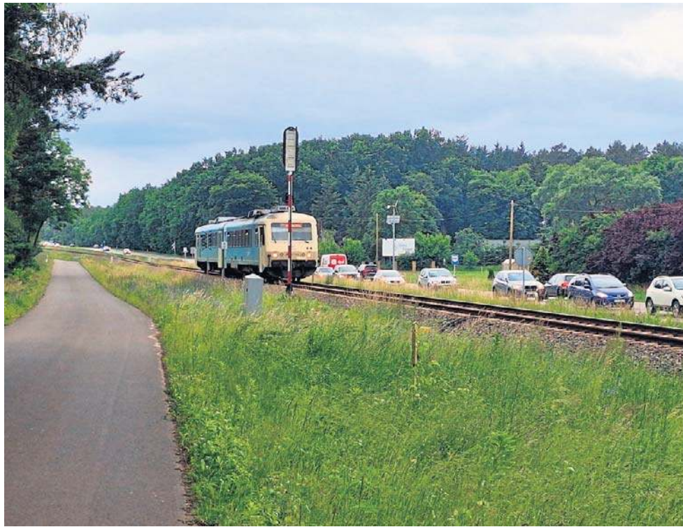
Szynobus stoi przed semaforem i czeka na opuszczenie rogatek na przejeździe kolejowym w Papowie Toruńskim - Osiekach. Samochody muszą go opuścić, by pociąg „dostał” wolną drogę. Ciągle na przejeździe dochodzi więc do niebezpiecznych sytuacji
