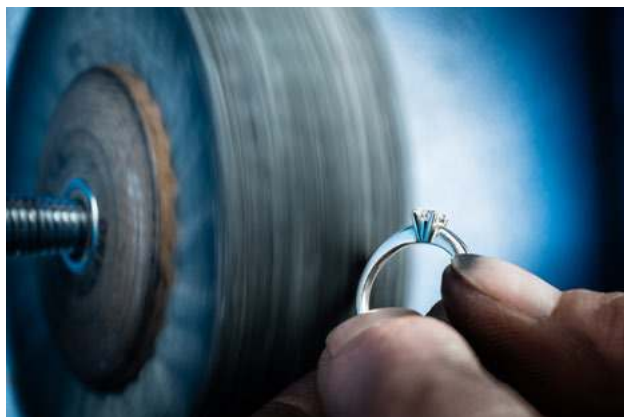
Szlifowanie i polerowanie nadają ostateczny wygląd wyrobu, foto Dreamstime
