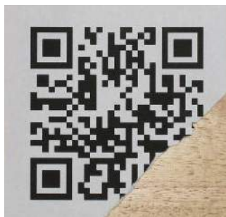
Fotografia 26. Poważnie uszkodzony kod QR, którego odczytanie wciąż jest możliwe dzięki zastosowanej korekcji błędów ( https://bit.ly/3C4fWL8 )
