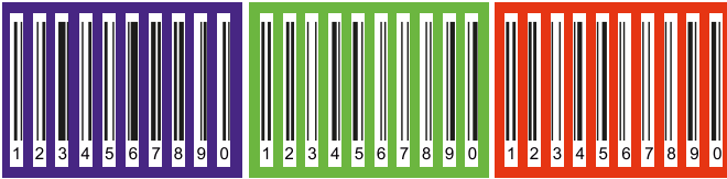
Rysunek 9. Sposób kodowania znaków według parzystości odd (na niebieskim tle) i even (na zielonym tle) dla lewej grupy znaków oraz even dla prawej grupy znaków (na czerwonym tle) – dotyczy kodu EAN-13 ( https://bit.ly/3p7fV1p )
