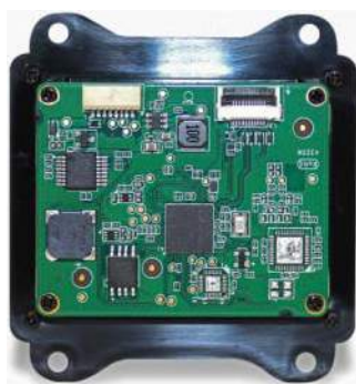
Fotografia 6. Moduł silnika skanującego EM20-85 – widok z tyłu ( https://bit.ly/3CM1x8v )
