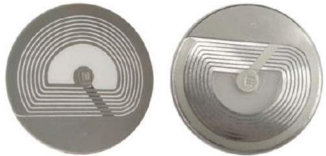
Fotografia 3. Naklejka antykradzieżowa RFID pracująca w paśmie 8,2 MHz ( https://t.ly/_ShWY )
