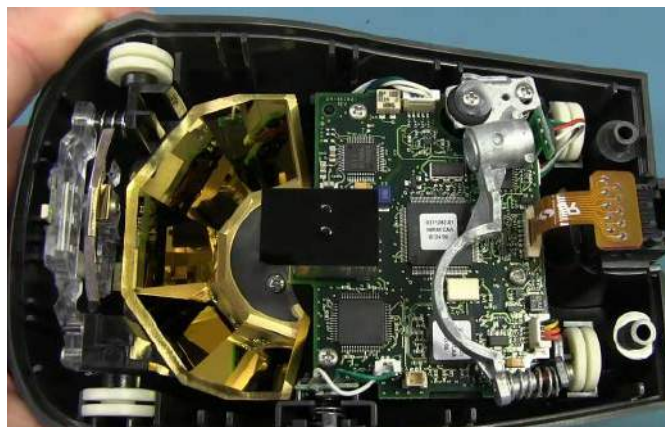
Fotografia 18. Wnętrze wielokierunkowego skanera kodów kreskowych symbol LS9208 marki Motorola ( https://t.ly/Ep_B )
