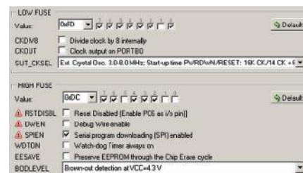
Rysunek 3. Szczegóły ustawienia bitów zabezpieczających
