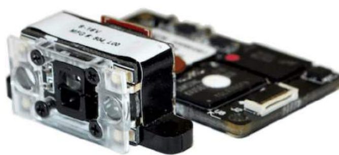
Fotografia 3. Czytnik CR8000 marki Code Corporation, wyposażony w podwójną optykę ( https://bit.ly/3wm0Tcp )
