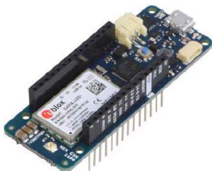
Fotografia 6. Moduł Arduino MKR GSM 1400 do realizacji komunikacji w sieci GSM/3G
