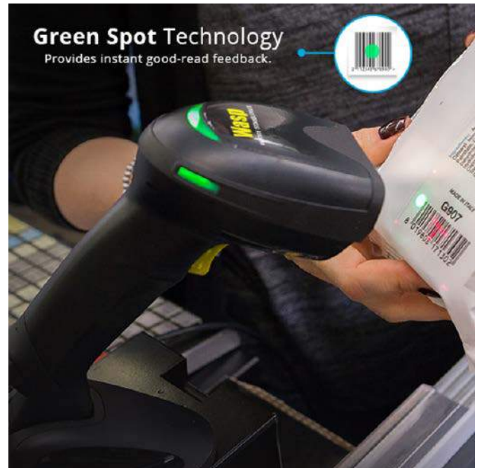
Fotografia 25. Ręczny czytnik kodów 1D/2D – Wasp WD14700. Widoczny efekt działania celownika laserowego (czerwony krzyż centralny i punkty określające obszar skanowania) oraz zielona plamka, informująca o poprawnym dokonaniu odczytu ( https://bit.ly/3dmdp4X )
