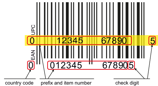
Rysunek 6. Porównanie kodów EAN-13 i UPC-A ( https://bit.ly/3A69guQ )
