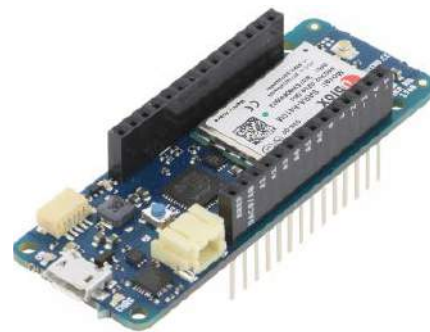
Fotografia 7. Moduł Arduino MKR NB 1500 do realizacji komunikacji w sieciach Narrowband IoT
