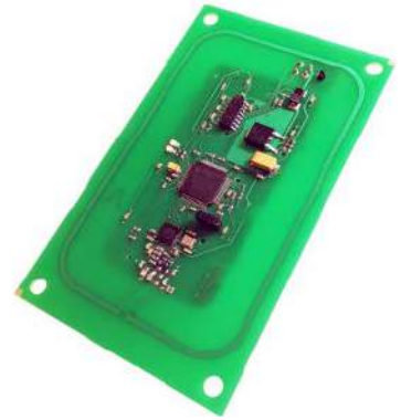
Fotografia 10. Moduł RFID typu NP11 marki Netronix ( https://bit.ly/3CC3Fy9 )
