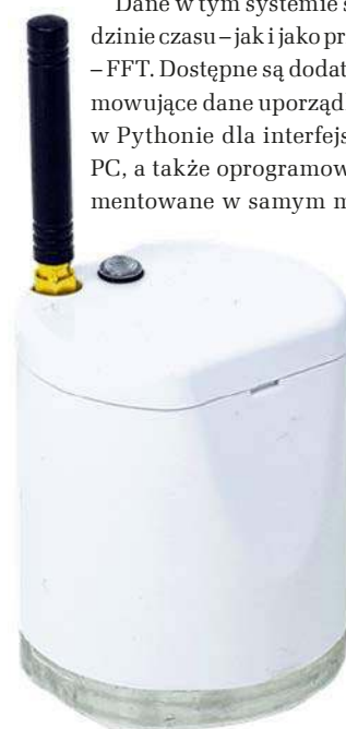
Fotografia 1. Platforma oceny bezprzewodowego monitoringu drgań
