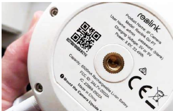
Fotografia 14. Tabliczka znamionowa kamery IP z widocznym kodem QR, przechowującym numer seryjny urządzenia ( https://t.ly/aFjt )
