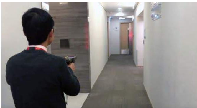
Fotografia 5. Zaawansowany komputer mobilny ze skanerem kodów kreskowych CipherLab 9700 podczas testu zasięgu – prawidłowy odczyt kodu (zaznaczonego strzałką) został wykonany z odległości przekraczającej 14 metrów ( https://t.ly/u-p4 )
