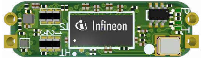
Rysunek 2. Płytkę prototypowego czujnika ruchu z detektorem BGT60LTR11AIP
