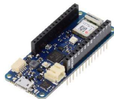
Fotografia 2. Moduł Arduino MKR WAN 1010 do realizacji komunikacji Wi-Fi
