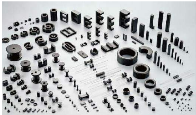
Fotografia 16. Portfolio dostępnych na rynku rdzeni ferrytowych do budowy „szytych na miarę” dławików i transformatorów jest dziś na tyle szerokie, że bez problemu można znaleźć odpowiedni produkt do każdej aplikacji
