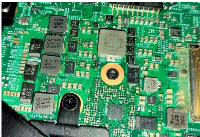
Fotografia 9. Sekcja zasilania laptopa marki Dell – widoczne są liczne (7 szt.) dławiki z pełnym ekranowaniem, współpracujące z przetwornicami DC/DC
