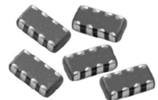
Fotografia 18. Ferrytowe, czterokanałowe „drabinki indukcyjne” marki Vishay o rozmiarach 3,2×1,6×0,9 mm
