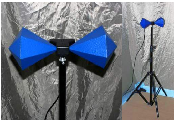
Fotografia 1. Detektor jest jednym z dwóch głównych elementów systemu do pomiaru EMI
