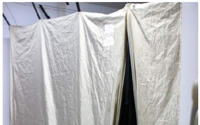
Fotografia 3. Pomiary EMI wykonywane są wewnątrz namiotu ekranującego, który został zrobiony z płótna przewodzącego prąd elektryczny
