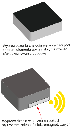
Rysunek 8. Wpływ wyekspozowanego padu na boku cewki na poziom EMI
