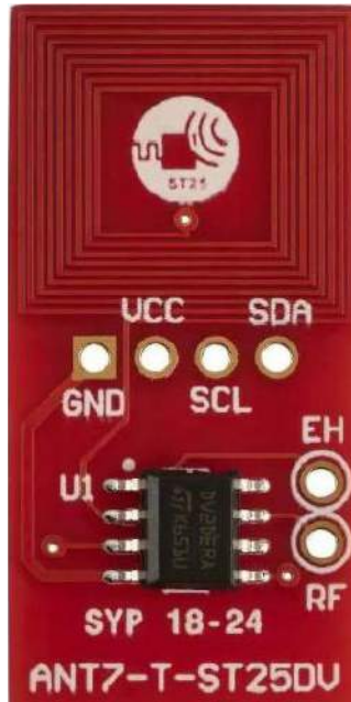
Fotografia 29. Przykładowa antena spiralna PCB, przeznaczona do komunikacji NFC – zestaw ewaluacyjny ANT7-T-ST25DV marki ST Microelectronics
