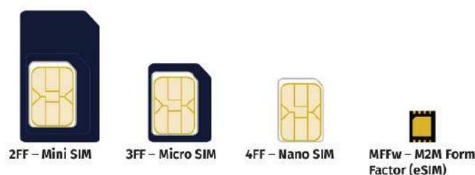
Rysunek 1. Różne formaty kart SIM, od najstarszego po lewej, do najnowszego, w postaci układu scalonego SMD montowanego bezpośrednio na płytce PCB urządzenia
