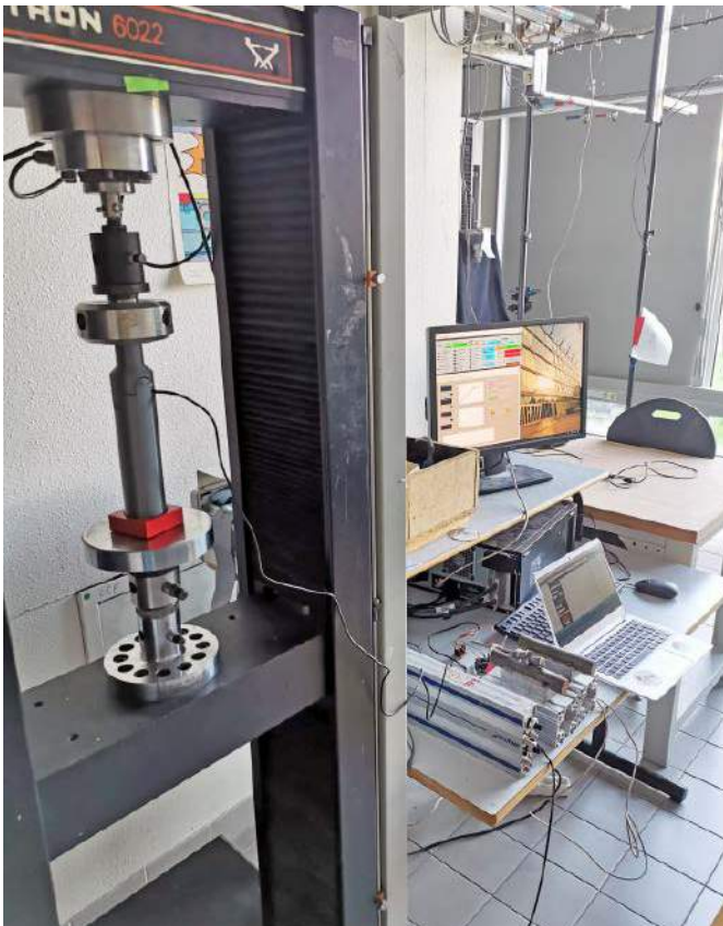
Fotografia 6. Układ do kalibracji – prasa mechaniczna z tłokiem umieszczonym w stanowisku pomiarowym
