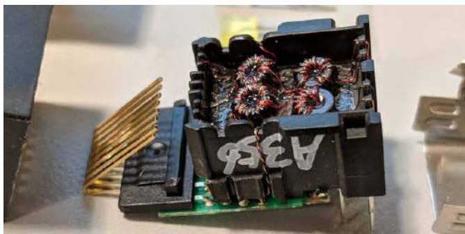
Fotografia 32. Wnętrze gniazda RJ45 ze zintegrowanymi transformatorami sygnałowymi
