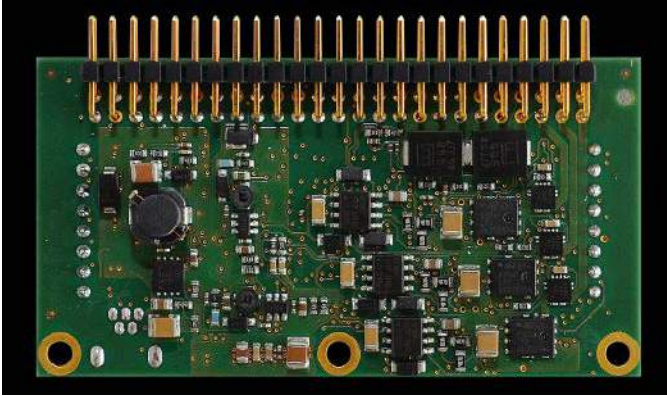
Fotografia 2. Kontrolery ruchu „szacują” temperaturę uzwojenia danego silnika na podstawie modeli o zróżnicowanej złożoności. Wymagane parametry są wygodnie przesyłane do kontrolera napędu z poziomu okna dialogowego wyboru silnika w oprogramowaniu Motion Manager
