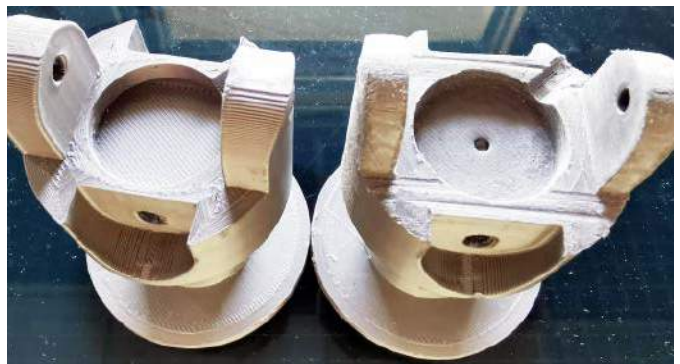
Fotografia 3. Wygląd nowego elementu (na górze) i uszkodzonego (na dole)
