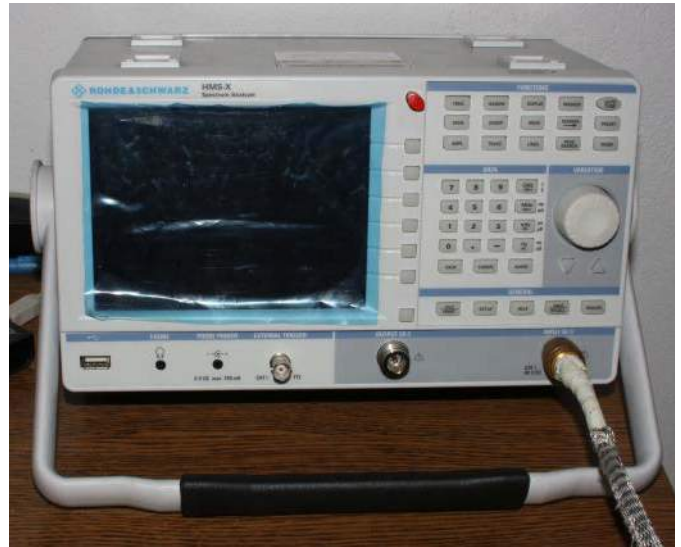
Fotografia 2. Analizator widma to wyspecjalizowany przyrząd pomiarowy umożliwiający pomiar EMI
