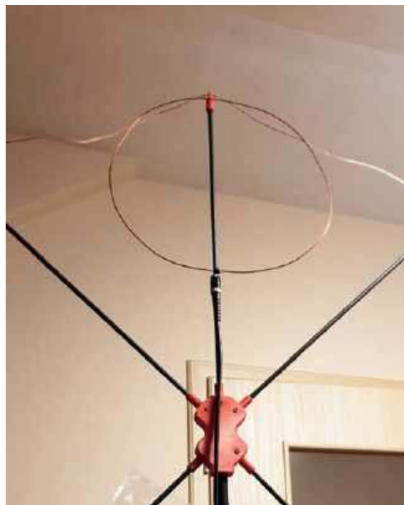
Wybrane szczegóły konstrukcyjne anteny magnetycznej SP2Z
