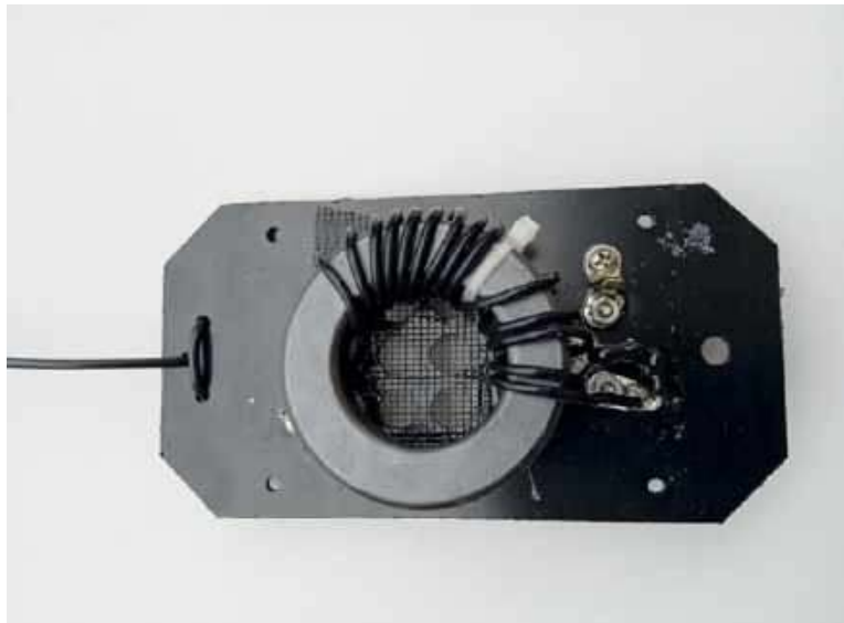
Toroidalny transformator 1:7 o przekładni impedancji 1:49 zawiera 14 zwojów z odcięciem na 2 zwoju. Pomiędzy gniazdem antenowym UC1 a odcięciem jest włączony kondensator 110 pF zestawiony z dwóch kondensatorów po 220 pF/500 V połączonych w szereg
