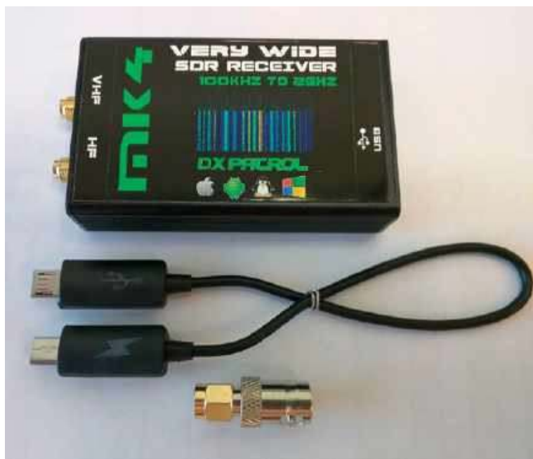
DX-Patrol zawiera odbiornik z układem RTL2832U i konwerter krótkofalowy
