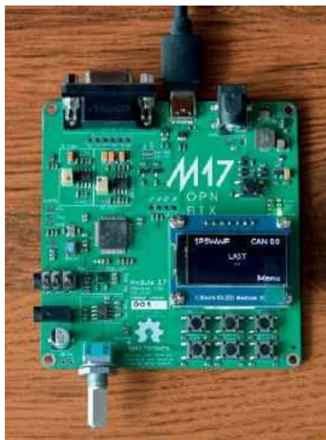
Module17 – modem M17 do analogowych transceiverów FM, wersja 0.1e
