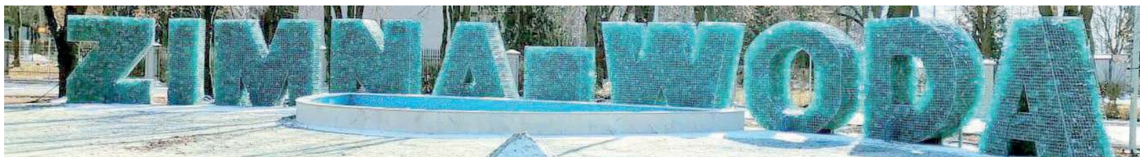
Wypoczywających nad zalewem powita napis „Zimna Woda” wykonany z koszy gabionowych w kształcie liter, wypełnionych bryłami ozdobnego szkła w kolorze turkusowym
