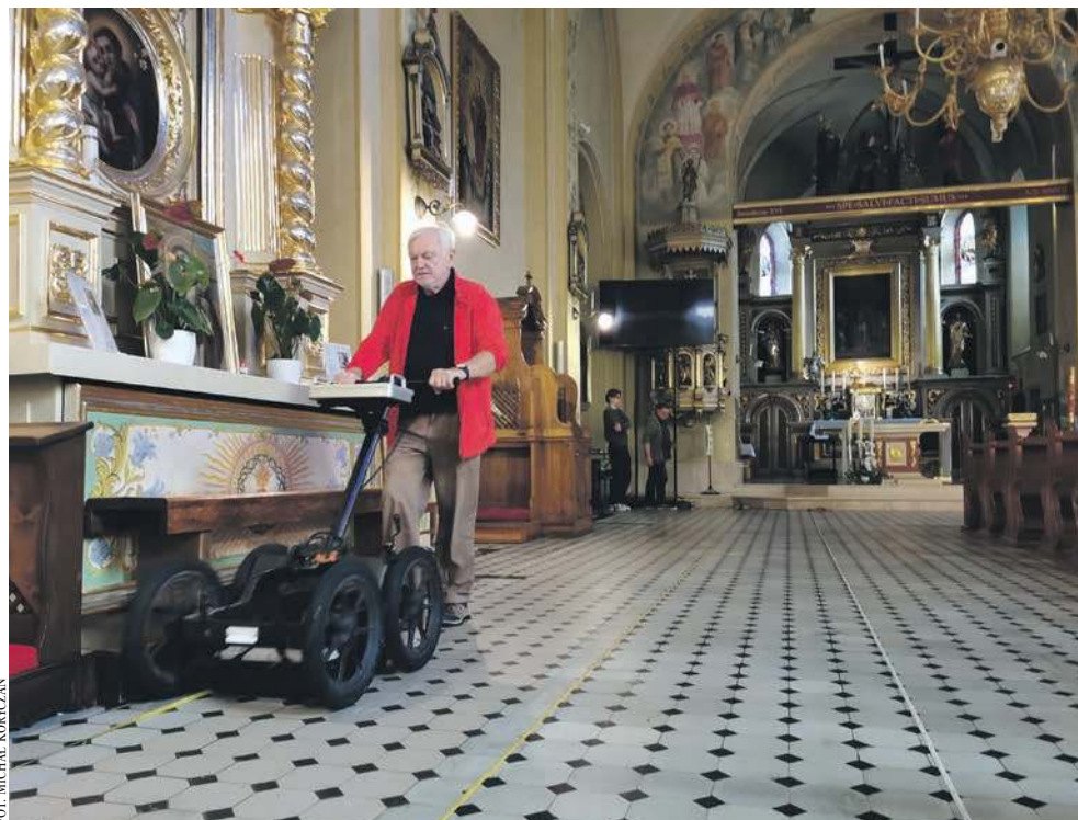
Tomasz Herbich prowadzi badania georadarem w kościele św. Mikołaja
