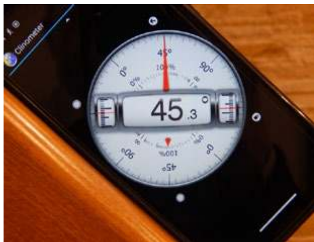
Rysunek 6. Działanie aplikacji Clinometer w telefonie komórkowym.
