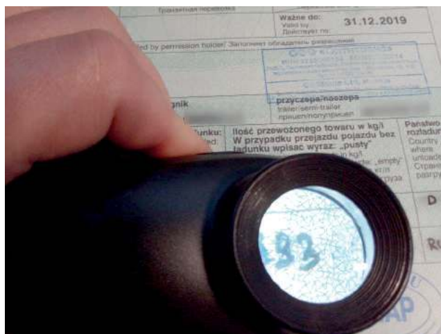
Urządzenie z użyciem promieni ultrafioletowych pozwoliło na wykrycie przeróbek w dokumencie
