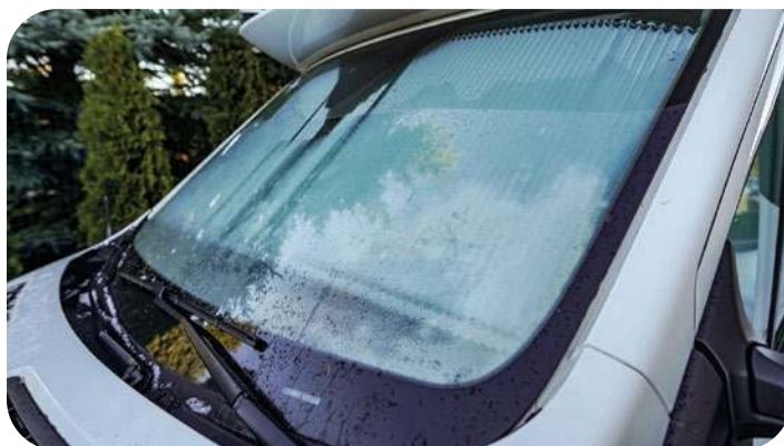
Skropliny po wewnętrznej stronie okien to zjawisko, które przypomina, że nadszedł czas na dodatkową izolację w postaci osłony termicznej na szyby
