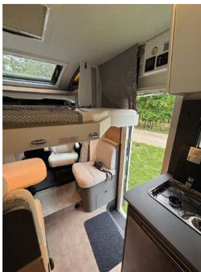
Przednie łóżko opuszczane jest jednoosobowe, natomiast warto docenić jego kształt, który nie blokuje wyjścia na zewnątrz pojazdu
