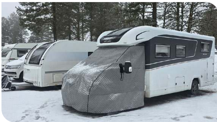
Pełna osłona termiczna kabiny półzintegrowanego kampera. Bardzo dobre rozwiązanie na zimę
