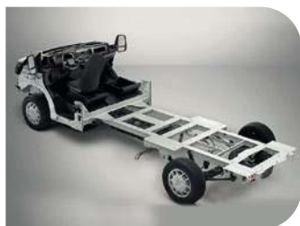
Podwozie Forda Transita w wersji L5 zachowuje krótki tylny zwis i daje dużą stabilność prowadzenia, mimo dość pokaźnych rozmiarów auta
