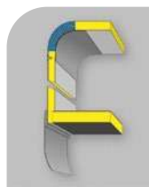
Łączenie dachu ze ścianami bocznymi zdecydowanie ogranicza potencjalne problemy ze szczelnością zabudowy
