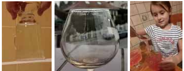
Rys. 6. Trzy doświadczenia „kuchenne” z cieczami. (a) Kartka papieru (ale nawet metalowa płytka) „przykleja się” do odwróconej szklanki z wodą. To ciśnienie atmosferyczne dopycha kartkę do szklanki, a napięcie powierzchniowe wody uszczelnia styk. Widoczny menisk w górnej części szklanki. (b) Słodkie wino tworzy „frędzle” na ściankach kieliszka: to współgrają napięcie powierzchniowe i lepkość. (c) Zuzia Wyborska robi kisiel, a właściwie eksperymentuje z cieczą nie-Newtonowską. (Foto KW i Maria Karwasz).
