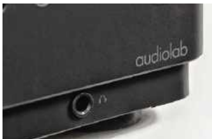
Wyjście słuchawkowe związane jest z niezależnym układem wzmacniającym.
