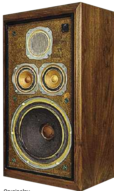
Oryginalny Model Five z 1968 roku. W swoim czasie bestseller, ale dzisiaj nie jest już wzorem do ślepego naśladowania. Wie to również konstruktor nowej wersji. Membrany były mieszanką włókien drzewnych, wełny, bawełny i dodatków bitumicznych.
