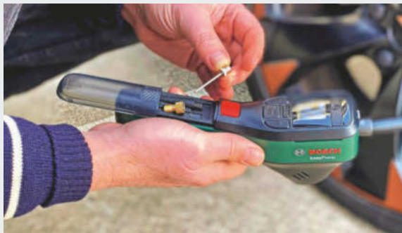
Adaptory do pompowania różnych przedmiotów osadzone pod przesuwaną osłoną. Zawsze są więc pod ręką.
