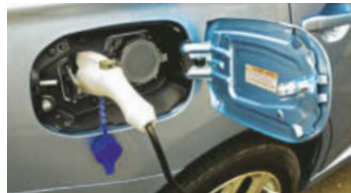
Gniazdo CHAdeMO pozwala na szybkie ładowanie akumulatora hybrydy.
