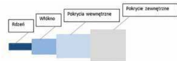
Rys. 2. Struktura prostego światłowodu.
