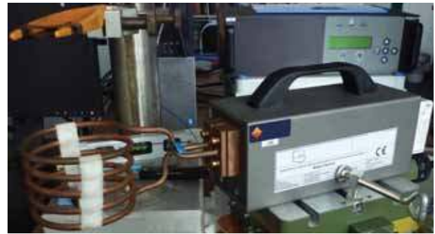
Fot. 2. Urządzenie do indukcyjnego nagrzewania rozтворów nanocząstek stosowane w badaniach nad hipertermią magnetyczną.
