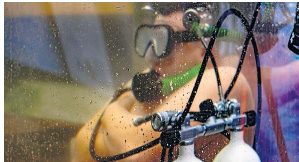
Próba odbywa się w pełnym zanurzeniu, a śmiełek oddycha poprzez aparat tlenowy
