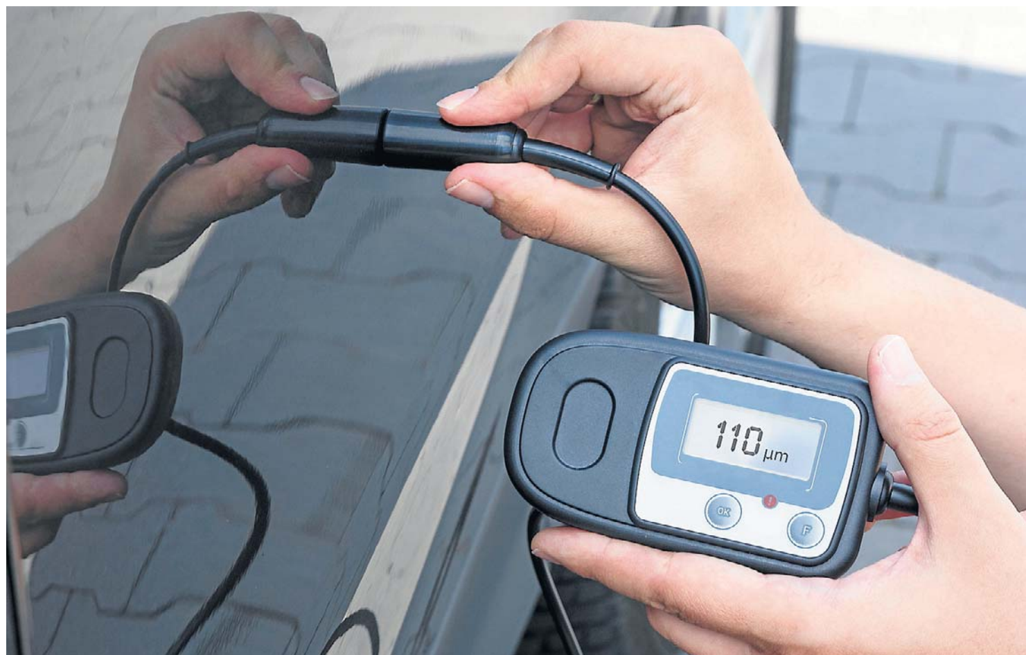
Najłatwiej dostępnym i najtańszym „pomocnikiem” jest magnetyczny tester do sprawdzania grubości lakieru. Na pomoc można też liczyć ze strony rzeczoznawców samochodowych. Informacje o samochodzie można uzyskać w dobrze wyposażonej stacji obsługi
