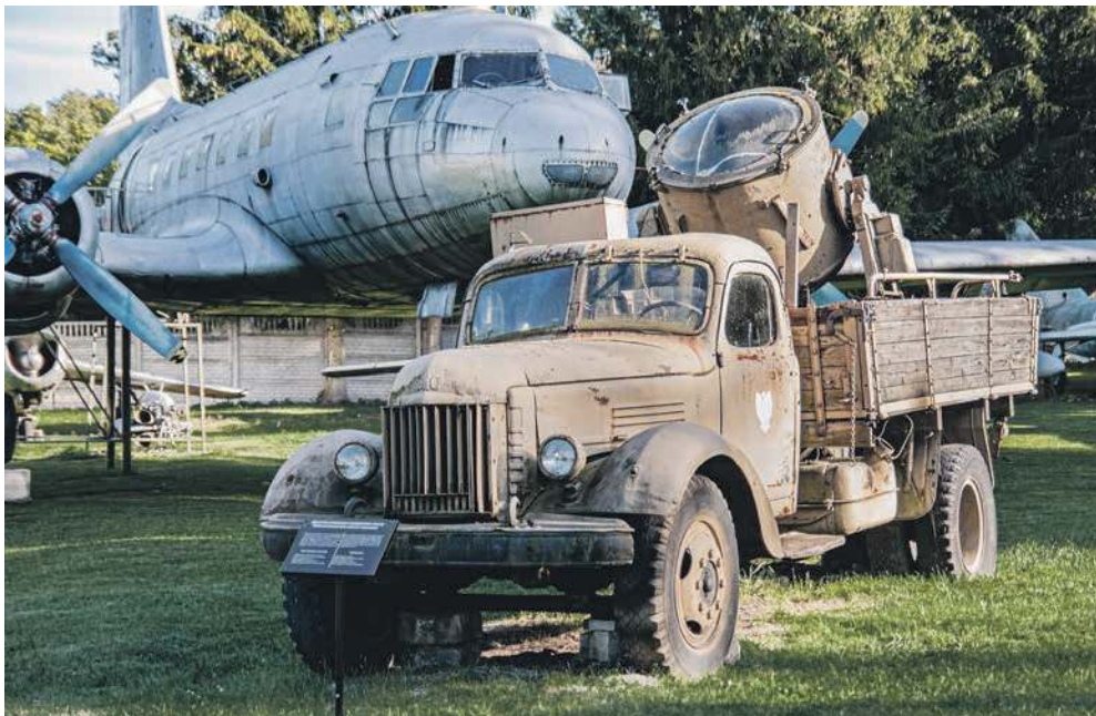
Reflektor lotniskowy nawigacyjny APM90 zamontowany na ciężarówce ZIL, w tle Ił-14T
