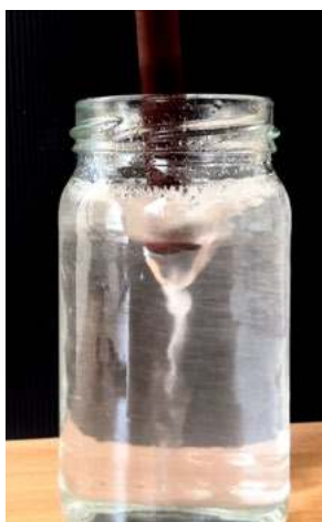
Fot. 6. Zagłębienie w wodzie spowodowane ruchem obrotowym.
