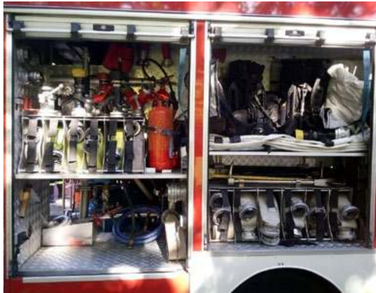
Fot. 4. W skrytkach wozu ratowniczo-gaśniczego przewożone są m.in. węże, prądownice, rozdzielacze, gaśnice i narzędzia ratownicze.
