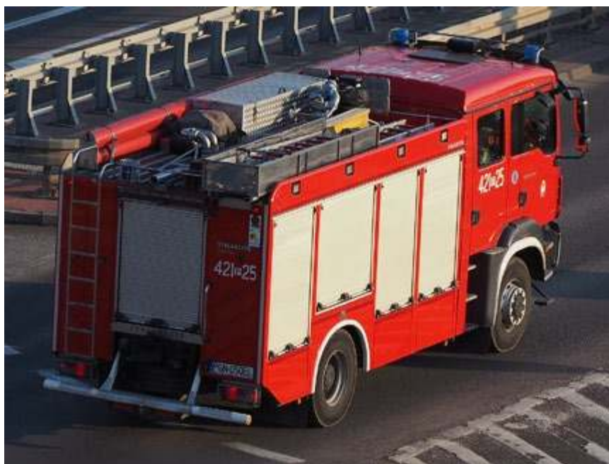
Fot. 2. Ciężki samochód ratowniczo-gaśniczy wyposażony m.in. w zbiornik wody o pojemności 5000 litrów, autopompę o wydajności 3200 l/min oraz zestaw umieszczonych na dachu drabin.
