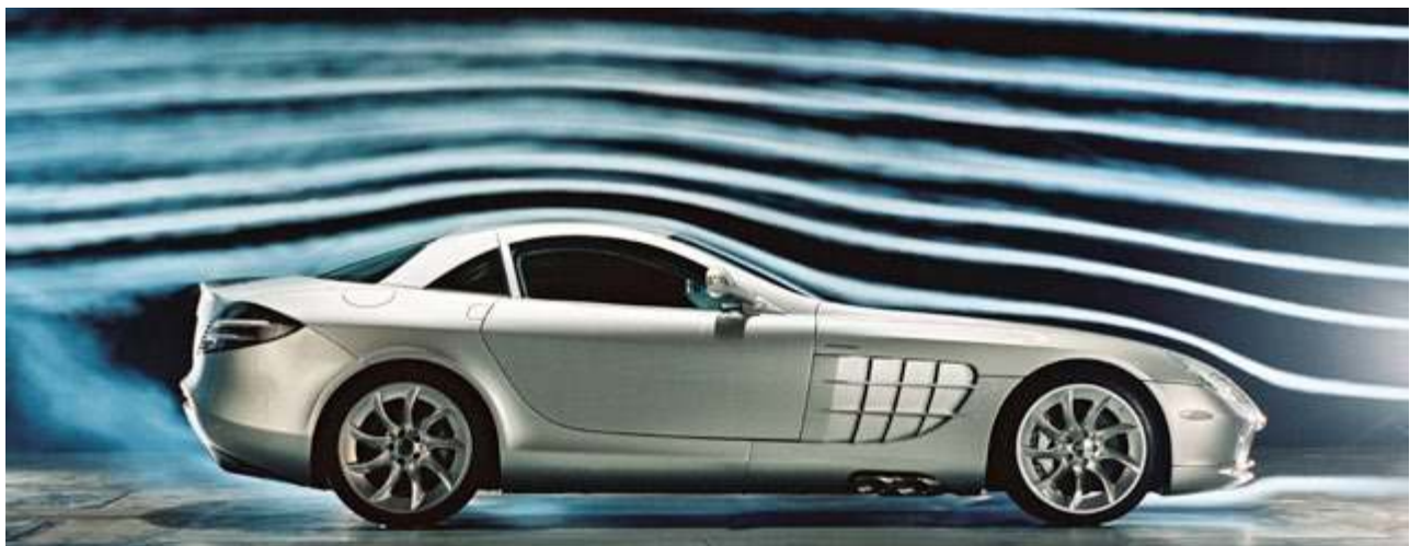
Rys. 1. Zagęszczenie strug występujące przy opływie ciała stałego.
