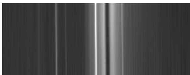
Rys. 6. Widmo ulicznej lampy sodowej uzyskane przy wykorzystaniu kamery Hyper-Cam178M, obiektywu Canon 18-55 mm oraz siatki dyfrakcyjnej 500 linii/mm. W widmie widać silne linie emisyjne sodu oraz ciemną linię absorpcyjną.
