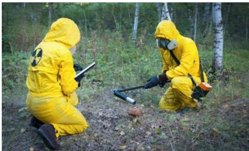
Pomiar poziomu promieniowania przy pomocy dwóch dozymetrów i licznika Geigera – Adobe Stock.
