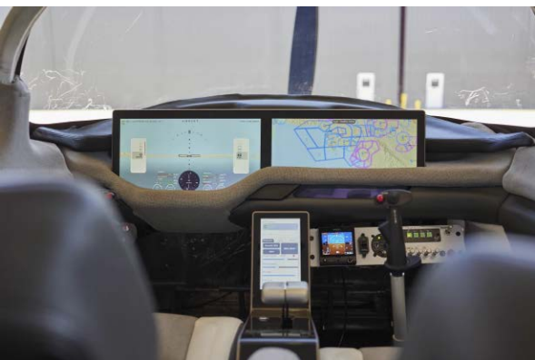
12. Widok kokpitu z dźwążkiem Airhart Assist widocznym po prawej stronie © Airhart Aeronautics
