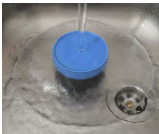
3. Odskok hydrauliczny i rozptyw wody na pokrywce pudełka od pasty do czyszczenia naczyń
