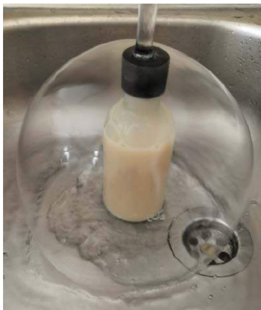
2. Odskok hydrauliczny i rozptyw wody na zakrętkę plastikowej butelki od szamponu
