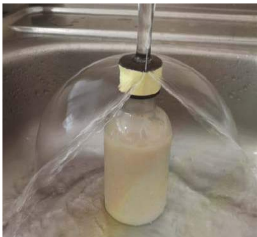
7. Model domku utworzonego z wody w wyniku jej odskoku hydraulicznego i rozptyłu na zakrętce plastikowej butelki od szamponu z ogranicznikiem wykonanym z kawałka drutu (fragment spinacza biurowego), przymocowanym taśmą klejącą do brzegu zakrętki
