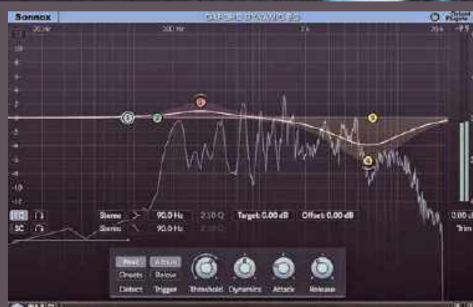
↑ Sonnox Oxford Dynamic EQ to przykład wzorcowego jakościowo i funkcjonalnie wielopasmowego korektora dynamicznego, w którym każdy z filtrów jest swego rodzaju procesorem dynamiki działającym w wybranym paśmie częstotliwości.
