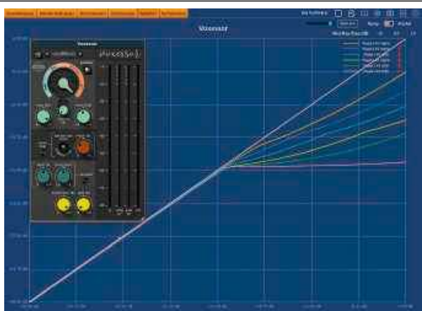
Praca kompresora zależy od wielu czynników i jest kontrolowana charakterem sygnału. Można jednak w przybliżeniu zmierzyć jej charakterystyki dynamiczne w kontekście różnych ustawień kontrolki Compressor.
