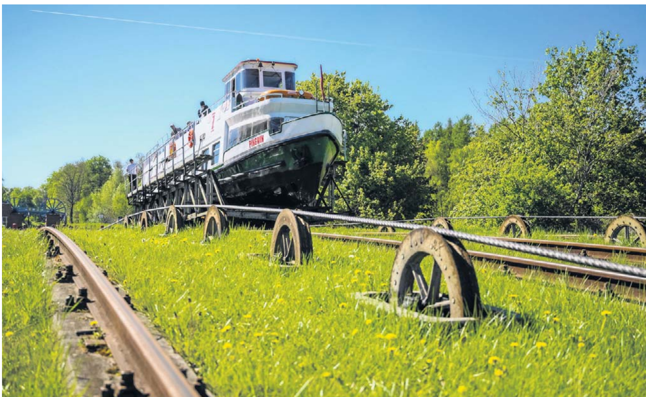
Statki pokonujące najciekawszy odcinek kanału „jadą po trawie”, pokonując różnice wysokości na platformach
