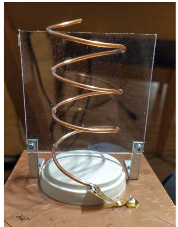
Antena helikalna na 2,4 GHz z zamontowanym konwerterem satelitarным w reflektorze
