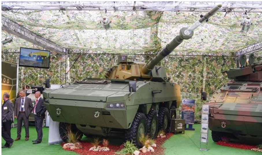
▲ Polski Rosomak z wieżą Cockerill z armatą kal. 105 mm u której wylotu widoczny pocisk kierowany Falarick 105 . Element ekspozycji podczas MSPO 2011.
