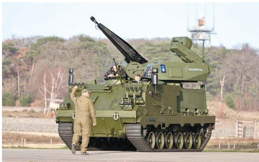
▲ Wśród systemów wymienianych jako potencjalnie wykorzystywane w terytorialnej OPL Szwecji wskazuje się także Rheinmetall Skyranger 30 (na zdjęciu posadowiony na gąsienicowym podwoziu FFG).
