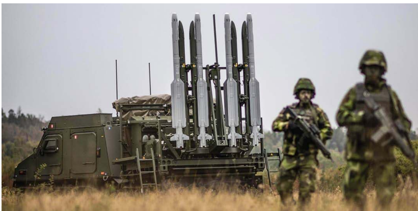
▲ Szwedzkie Siły Zbrojne wykorzystują już systemy przeciwlotnicze bardzo krótkiego zasięgu IRIS-T SLS wykorzystujące jako nośnik wszędolazy BvS 10. Współpraca z Diehl Defence jest kontynuowana, a kolejne zestawy Szwedzi zakontraktowali w ubiegłym roku.
