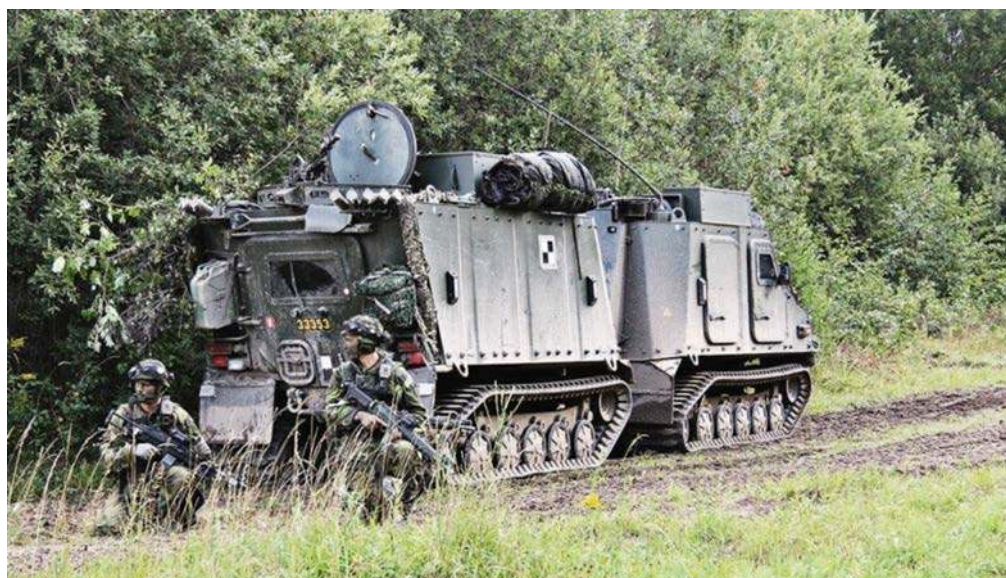
▲ Charakterystyczny wyróżnik pojazdów BvS 10 i jego poprzedników, czyli dwa kadłuby. Przy czym ten drugi jest głównie zadaniowy, czy to do transportu piechoty, wsparcia logistyki, dowodzenia czy innych zadań. Na zdjęciu ćwiczenia pododdziału szwedzkiego.
