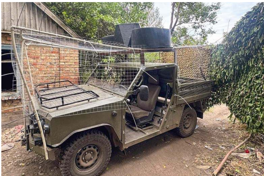
▲ Doposażony w siatki antydronowe pojazd Ural już na froncie. Plastikowe „miski” nad kabiną rzekomo chronią stacje WRE, ale patrząc na ich wygląd nie będzie zaskoczeniem, jeśli pod nimi nie ma kompletnie nic (jesień 2025 roku).
