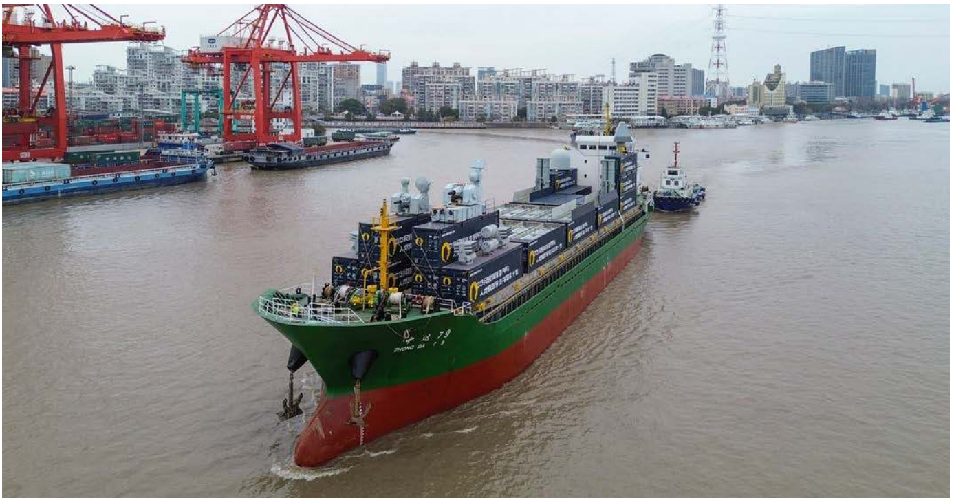
▲ Zhong Da 79 w pierwotnej konfiguracji, część makiet wyrzutni złożona, widoczny także brak górnych pokryw kontenerów.
