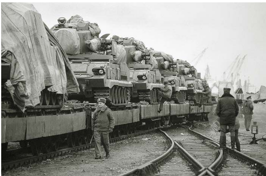
▲ Wozy bojowe systemu przeciwlotniczego 2K22 Tunguska załadowane na platformy kolejowe na bocznicy portu w Rostoku.
