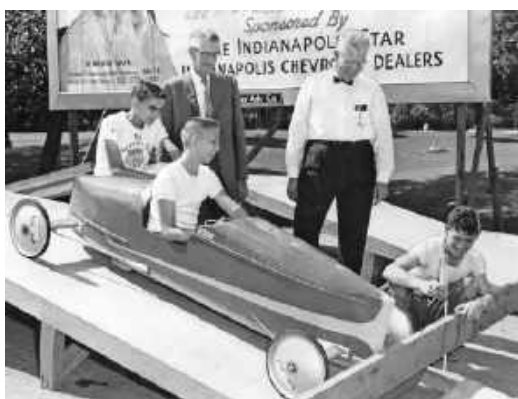
Inną odmianą pozwalającą na równoczesne startowanie zawodników był ogranicznik w postaci poprzecznej deski uchylnej poprzecznej deski, która chowała się w obrysie rampy. Współczesny model ramp z kątkiem startowym (fot. https://tiny.pl/01w2s6mb )
