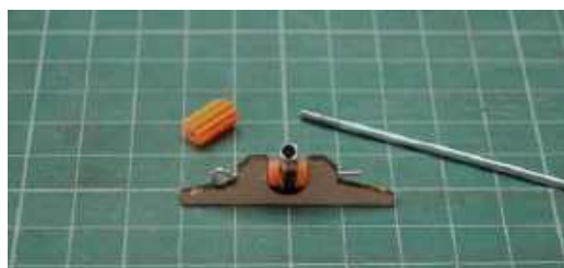
Tak wygląda pierwszy prototyp dźwigni, który następnie będzie przyklejony do osi mechanizmu
