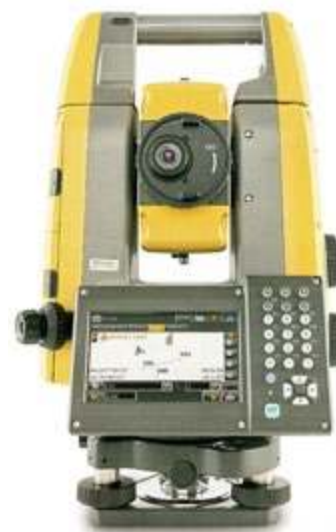
Fot. 5. Wygląd zewnętrzny współczesnego tachimetru.
