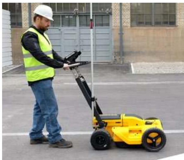
Fot. 8. Radar geodezyjny w czasie pracy.
