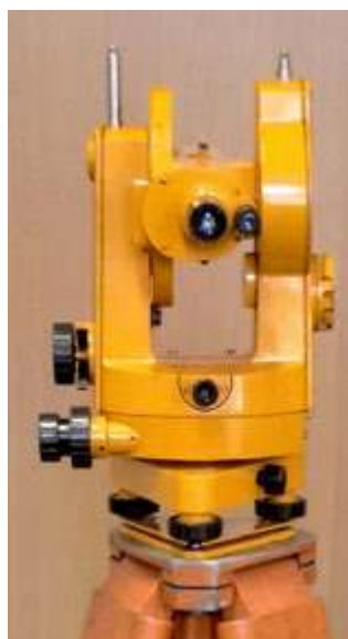
Fot. 4. Teodolit Dahlta 010B z lat osiemdziesiątych XX w.
