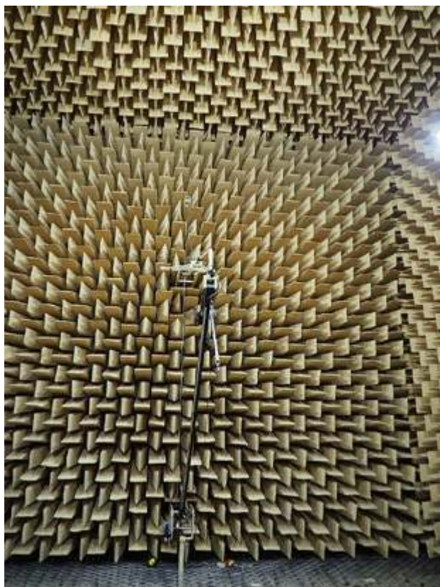
Fot. 1. Wewnętrzne powierzchnie komory bezechowej wyłożone są setkami elementów rozpraszająco-pochłaniających w postaci klinów.
