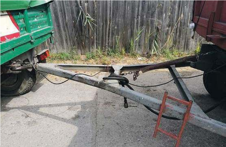
Tylna przyczepa zatrzymanego ciągnika nie posiadała sprawnego oświetlenia zewnętrznego oraz nie podłączono do niej przewodów hamulcowych.
