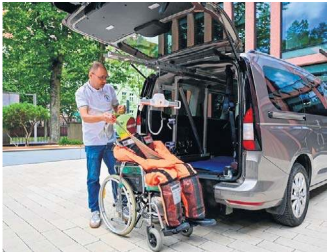
Metalowa konstrukcja pozwala przenieść osobę z wózka ustawionego przy tylnej klapie do wnętrza samochodu
